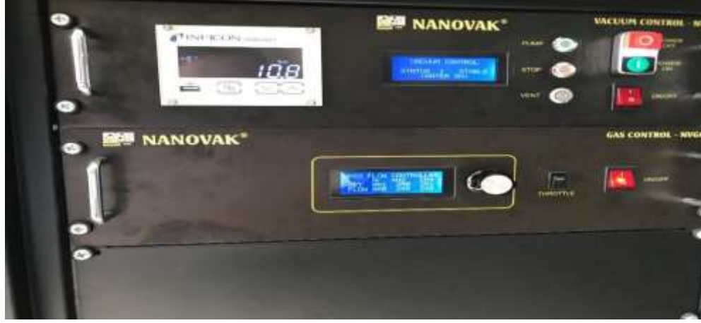
Şekil 19. Vakum ve gaz kontrol ünitesi
