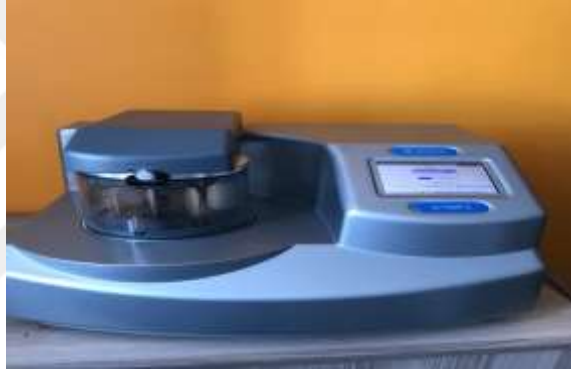
Şekil 26. Altın kaplama işlemleri için kullanılan sistem
