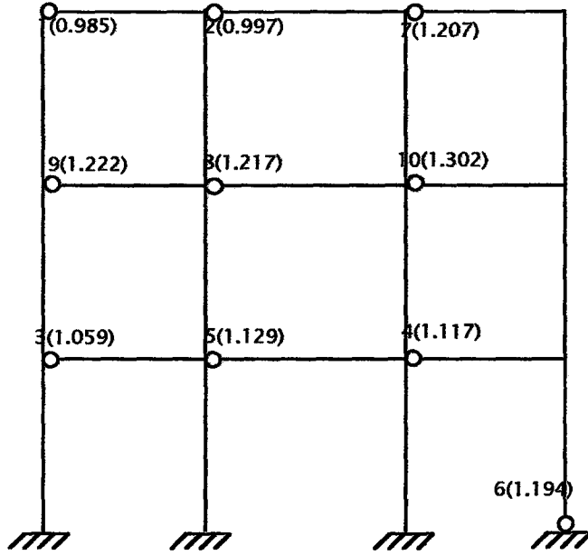
Şekil 3.6 Düşey ve sola doğru etkiyen yatay yükler için doğrusal hesaptan bulunan donatı oranları ile hesaplanan çerçevede plastik mafsalların gelişim sırası ve yük parametreleri
