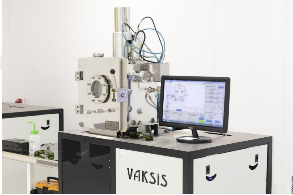
Şekil 12. Termal buharlaştırma ünitesi.
