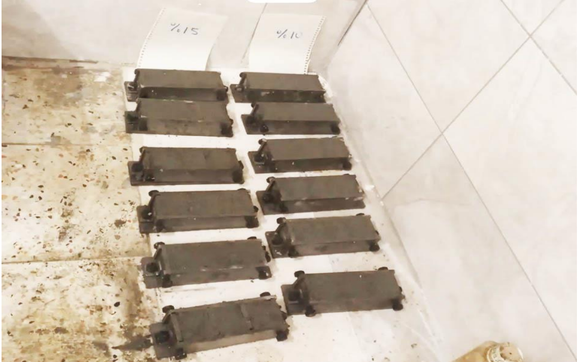
Şekil 12. Çelik kalıplar içerisindeki deney numuneleri
