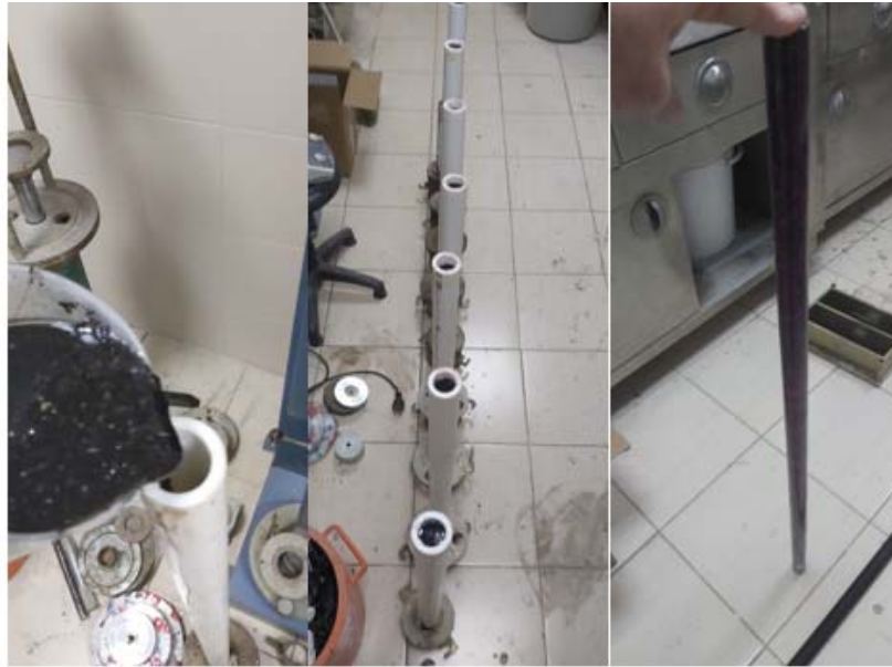
Şekil 35. Büyük ölçekli model kazık
