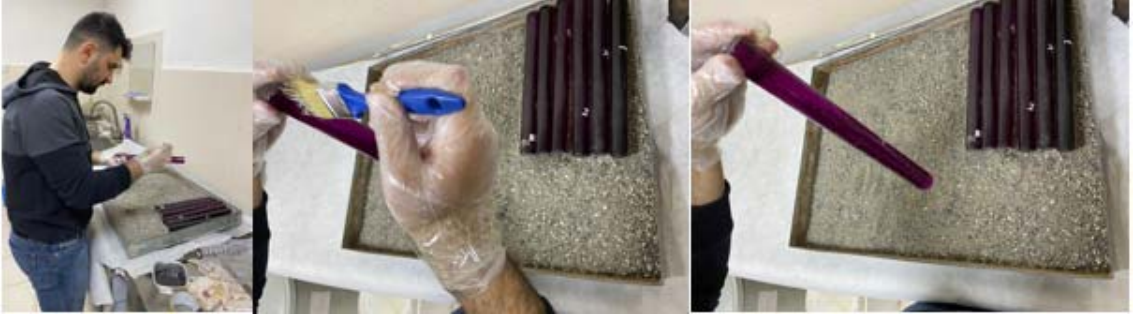
Şekil 38. Polimer malzemenin kazık yüzeyini kaplaması
