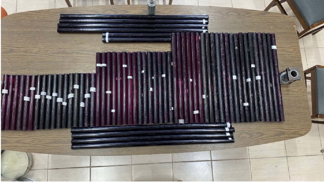
Şekil 36. Üretilen model kazıklar
