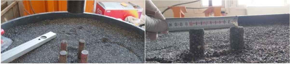
Şekil 40. Kazık numunelerinin yerleştirilmesi
