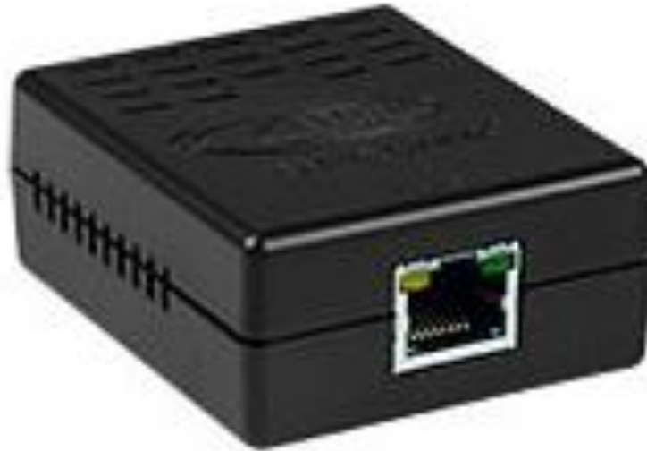
Şekil 3.10. E-STs sıcaklık ve nem sensörü görünümü (Network Technologies Incorporated 2019)
