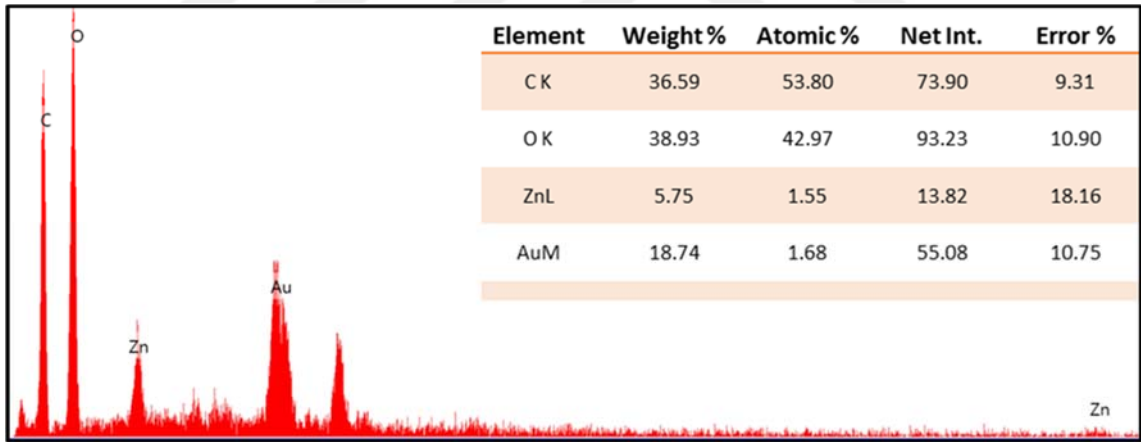
Şekil 51. Nişasta@ZnO/LPO film ait EDS spektrumu ve elementel dağılımı
