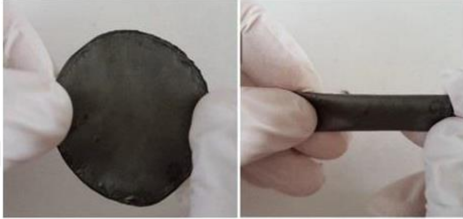
Şekil 2. Grafen kağıdın (a) serbest duran ve (b) esnek özelliklerini gösteren fotoğraflar (Erçarıkci et al. 2021)
