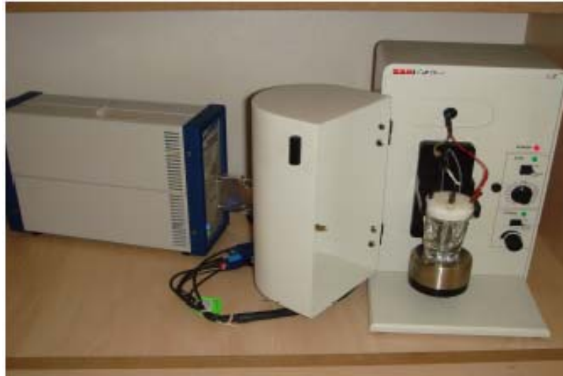
Şekil 3.1. Elektrokimyasal ince film büyütme sistemi (Gamry Reference 600 Potentiostat/Galvanostat)
