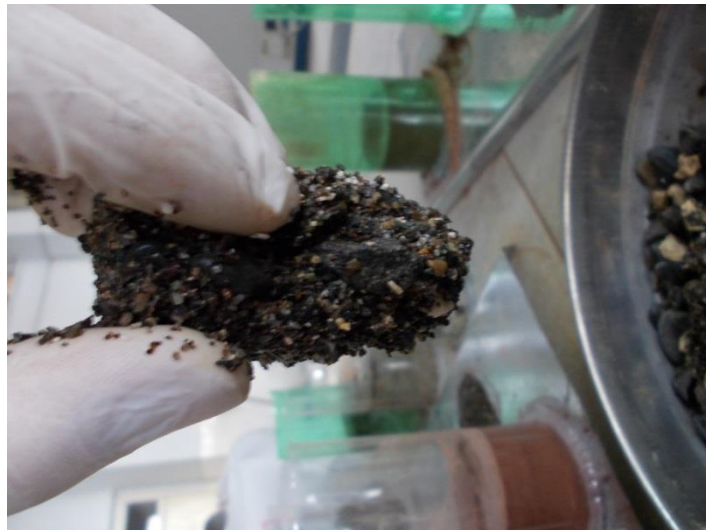
Şekil 4.2. 5 nolu numune (zemin tanelerinin birbirine tutunması)
