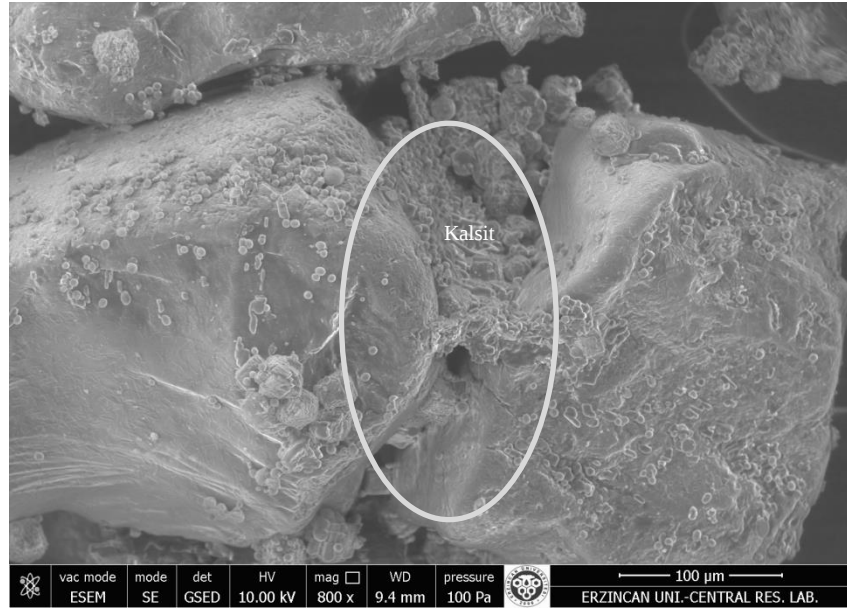
Şekil 4.24. pH 8,0 35°C 7 günlük etüv SEM analizi (800x)
