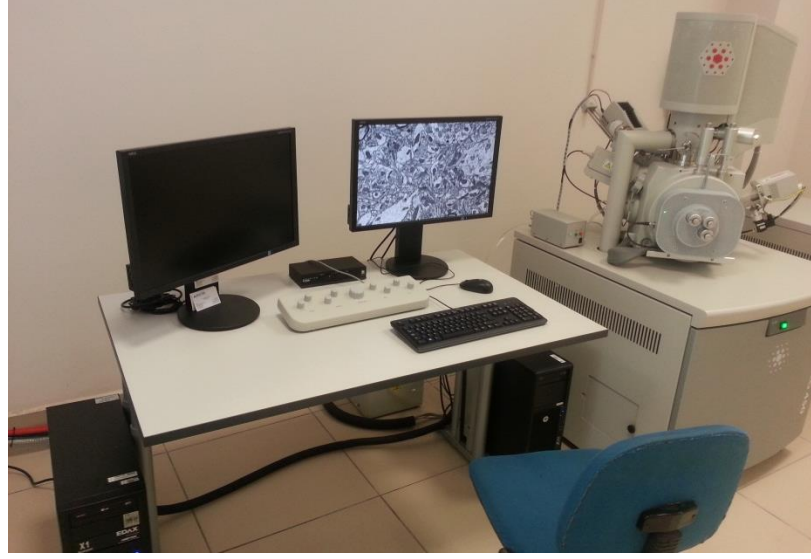
Şekil 3.13. Taramalı elektron mikroskobu (Quanta 450 FEG)
