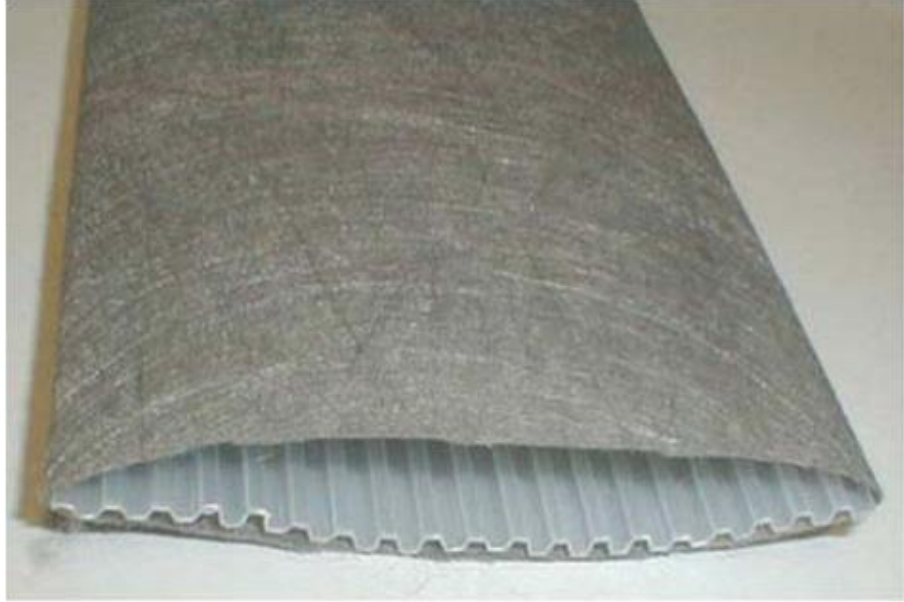
Şekil 2.3. Prefabrik düşey dren (Briaud 2013)
