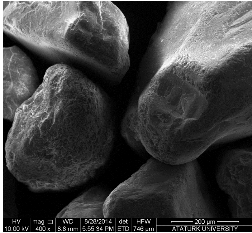
Şekil 4.13. Uygulama yapılmamış kum zemin SEM analizi (400x)
