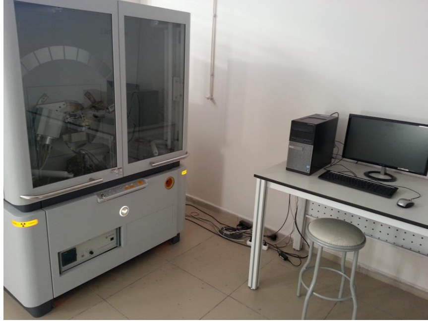
Şekil 3.14. X-ışını kırınım cihazı (Empyrean Series 2 X-ray Diffraction System)
