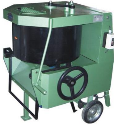
Şekil 3.11. Deneylerde kullanılmış betoniyer
