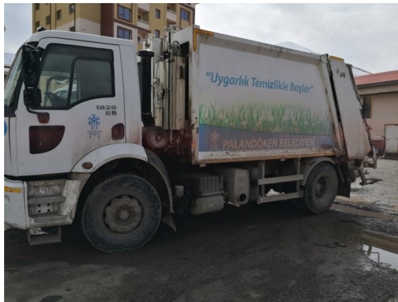
Şekil 4.3. Arkadan yüklemeli sıkıştırırmalı evsel atık toplama aracı
