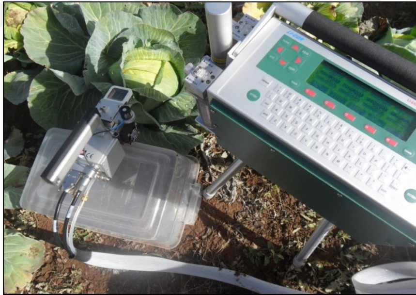
Şekil 3.18. LI-6400XT portatif fotosentez ölçer cihazı ile yapılan ölçümler (Orijinal resim).
