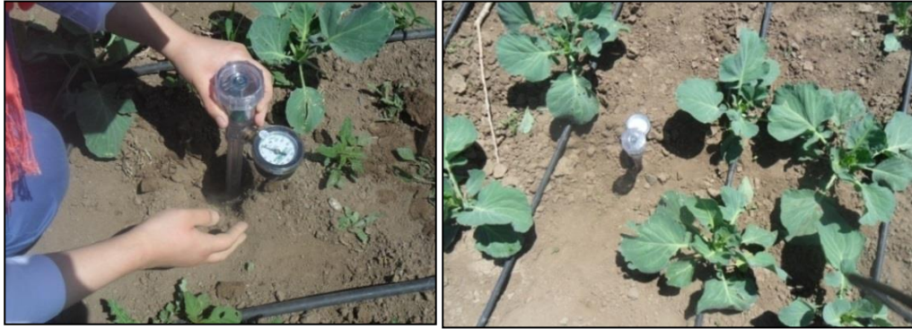
Şekil 3.14. Kontrol parsellerine yerleştirilen tansiyometreler (Orijinal resim).
