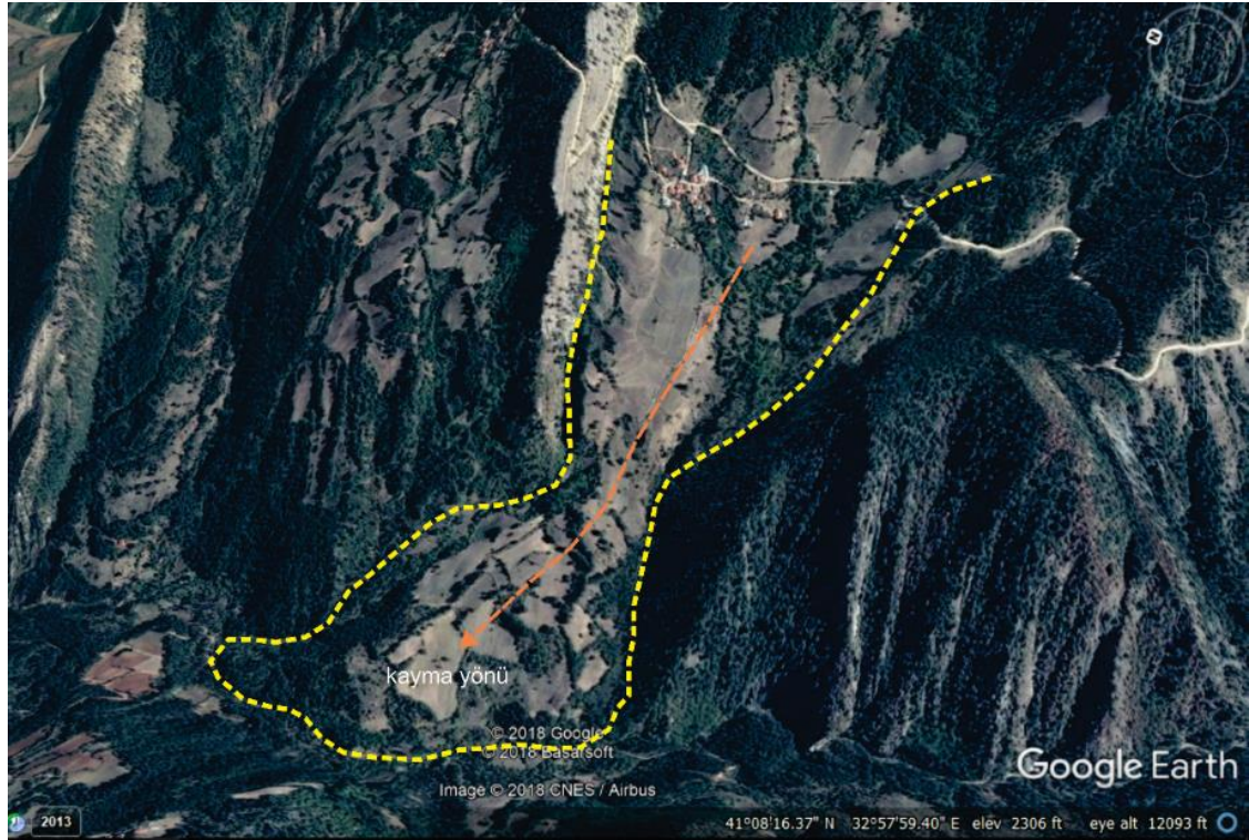
Şekil 4.5. İnceleme alanında gözlemlenen dairesel toprak kayması
