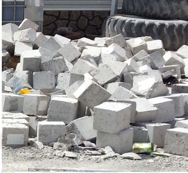
Şekil 3.1. Basınç dayanımı deneyine tabi tutulan beton numuneler
