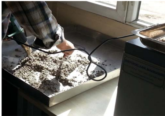
Şekil 3.5. İnce GDA'nın doymun kuru yüzey haline getirmesi
