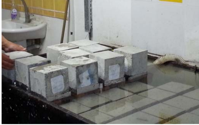
Şekil 3.11. Beton numunelerinin su yüzeyine yerleştirilmesi
