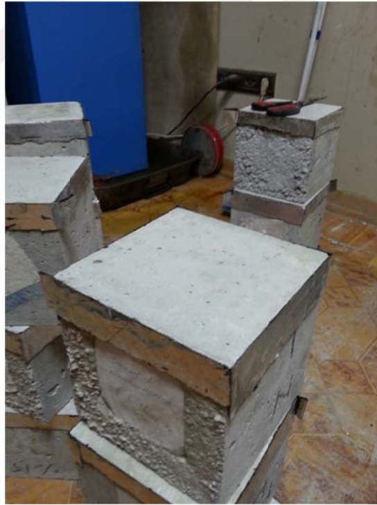
Şekil 3.10. Kılcal geçirimliliğin tespit edilmesi
