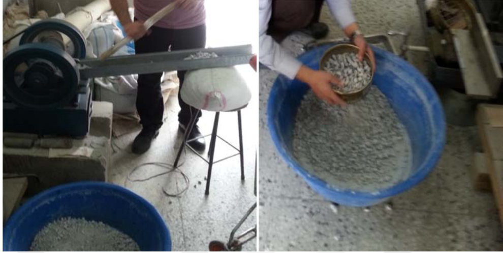
Şekil 3.3. Beton parçalarının mobil konkasörde öğütülmesi ve istenen elek boyutunda elenmesi
