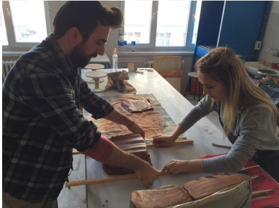
Foto 27. İki adet ahşap çubuk yardımıyla kil kütlesinden ince plakaların kesilme işlemi.
