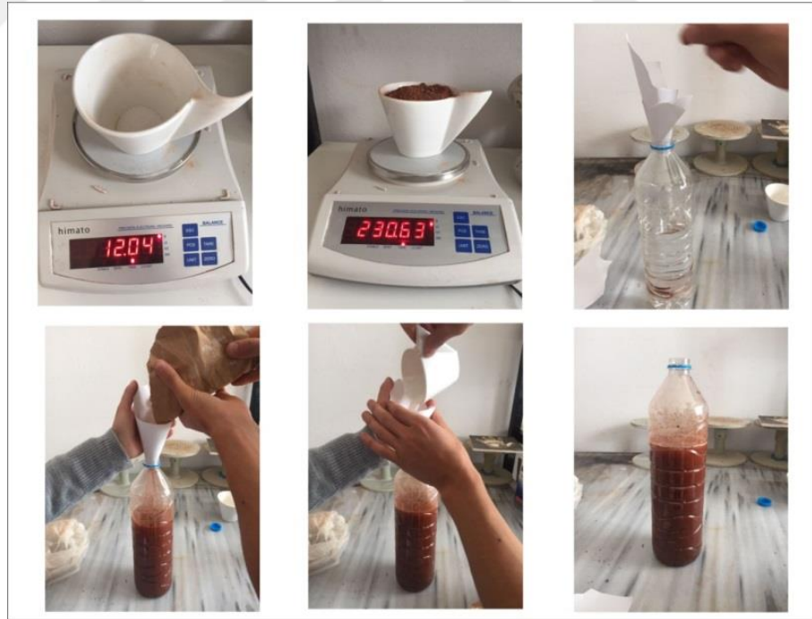
Foto 37. Seramik astarının hazırlanma aşaması.
