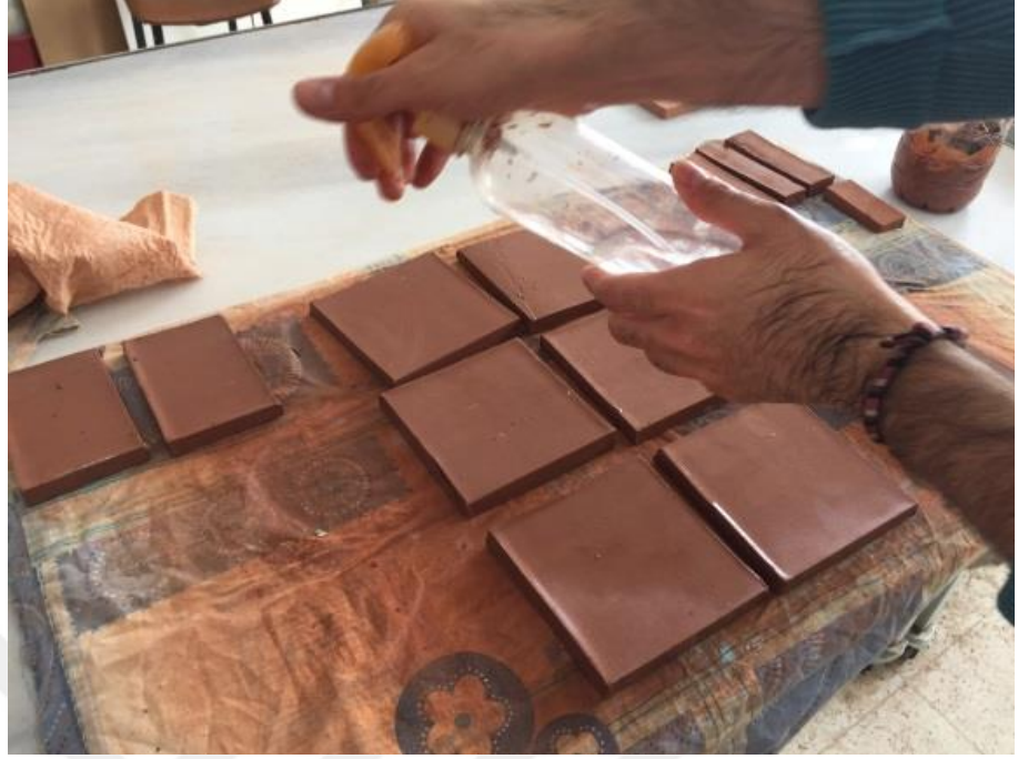
Foto 38. Kil plakaların nemlendirilmesi.
