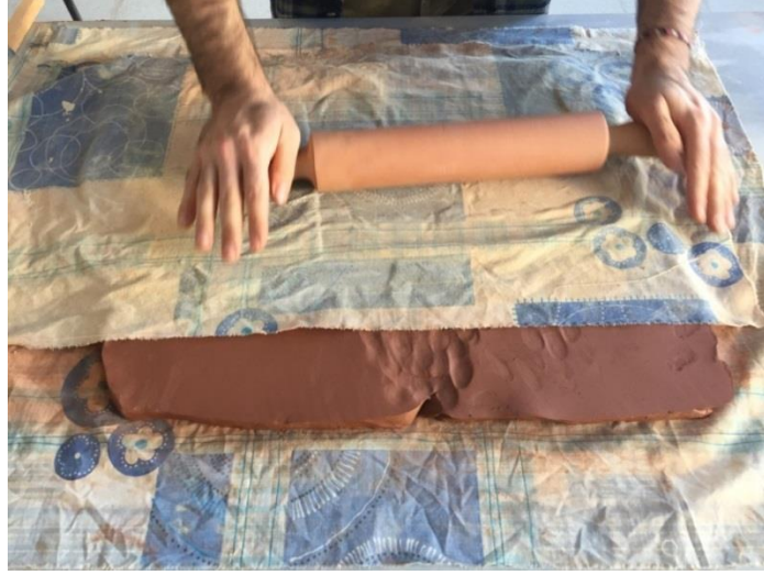
Foto 32. Birleřtirilen kil plakalarının bir merdane yardımıyla birbirlerine birleřtirilme ařamasası.
