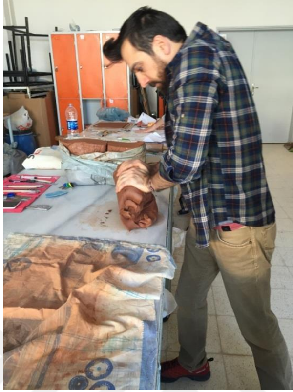
Foto 28. Kil plakaların üst üste koyularak “öküz başı” metodu ile yoğurulması.
