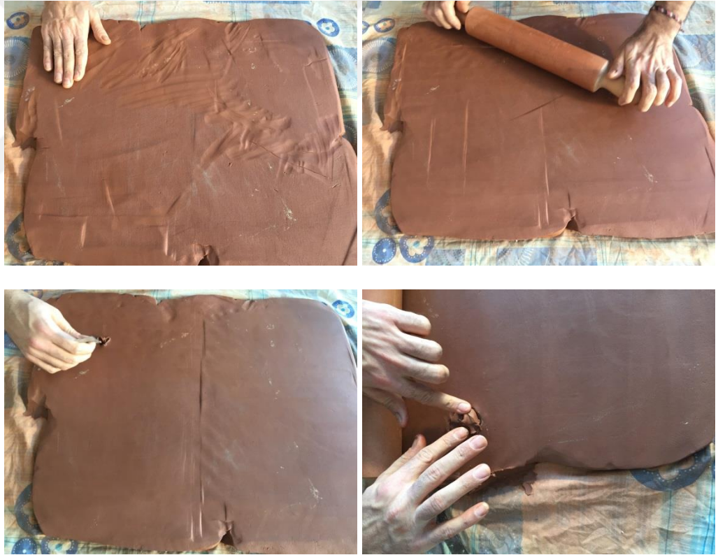
Foto 33. Kil plakanın ierisinde oluřan hava kabarcıklarının yok edilmesi.
