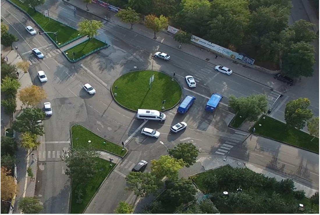
Şekil 28. İstanbulkapı kavşağı (Dönel sinyalizasyon kavşak)
