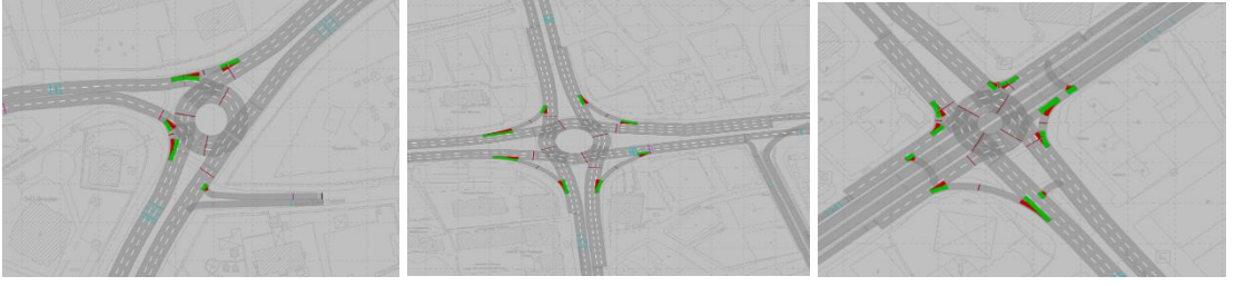
Şekil 54. Mevcut sinyalizasyonun ileriye alınması (Conflict area düzenlemesi)
