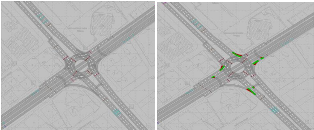
Şekil 57. İstasyon kavşağı ada çapının artırılması
