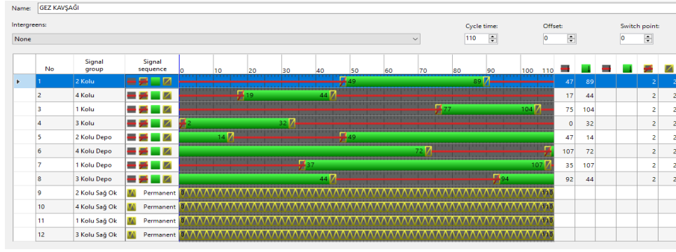
Şekil 64. Gez kavşağı sinyalizasyonların ilerde olması durumu sinyal programı
