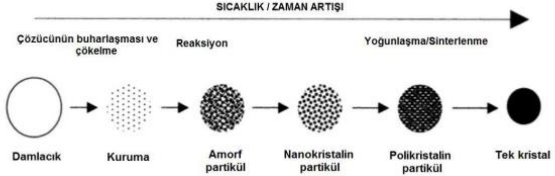
Şekil 1.4. Sprey piroliz prosesinin şematik gösterimi (Gençer 2009)
