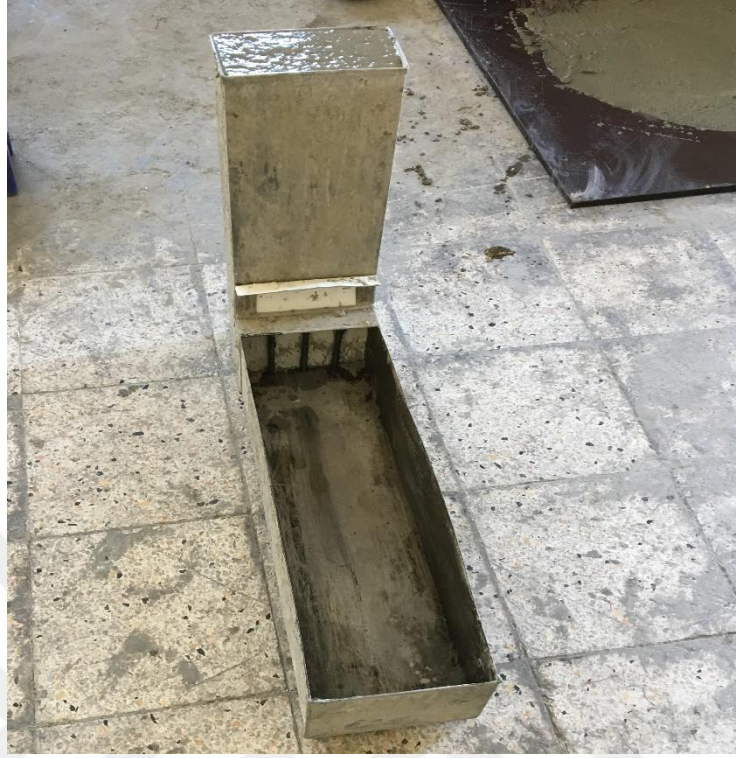
Şekil 3.9. Kendiliğinden yerleşen betonda L - kutusu deneyi uygulaması
