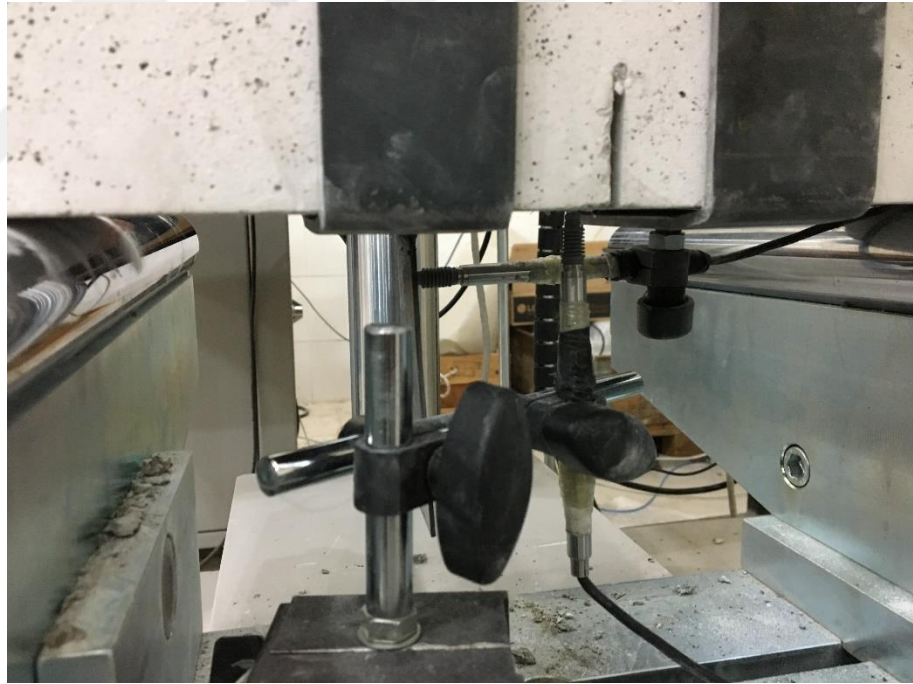
Şekil 3.12. Çentikli numunelerde üç noktalı eğilme deneyinin uygulaması
