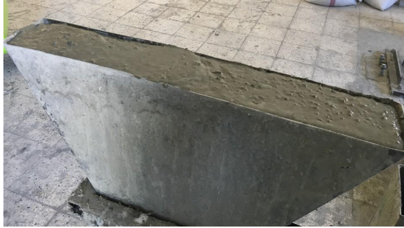
Şekil 3.8. Kendiliğinden yerleşen betonda V - hunisi deneyi uygulaması
