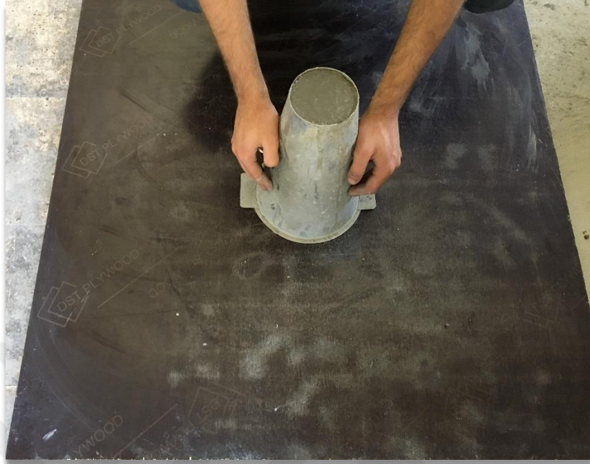
Şekil 3.7. Kendiliğinden yerleşen betonda çökme yayılma deneyi uygulaması
