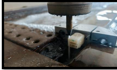
Şekil 3.8. Su Jet cihazıyla örneklerin hazırlanması
