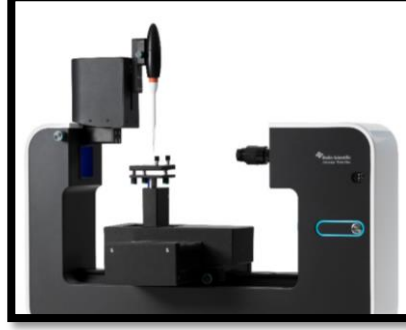
Şekil 3.18. Temas açısı ölçüm cihazı
