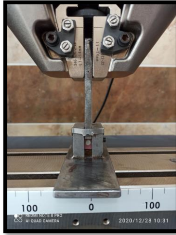
Şekil 3.25. Örneklere test cihazı ile kuvvet uygulanması
