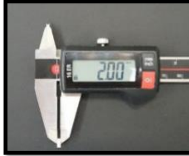
Şekil 3.6. Örnek boyutlarının kalınlık ölçer ile ölçülmesi
