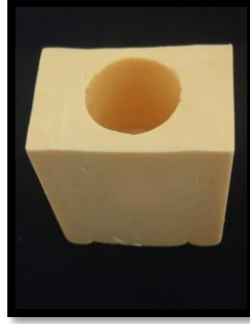
Şekil 3.20. Akrilik rezine gömme işleminde kullanılan silikon kalıp
