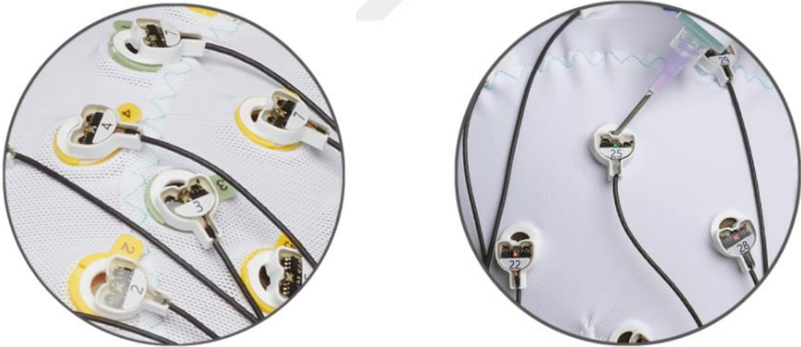
Şekil 19. 32 Kanallı EEG Elektrotları (Brain Products, 2023b)
