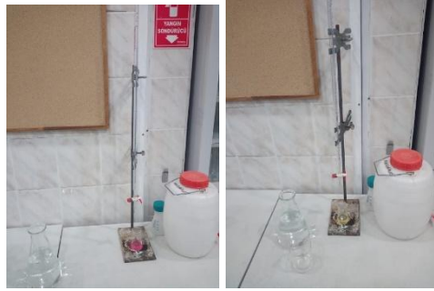
Şekil 22. NO 3 -N içeriğinin belirlenmesi
