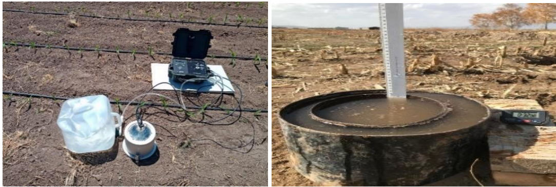
Şekil 25. Otomatik infiltrometre ve çift silindirli infiltrometre ile infiltrasyon ölçümleri
