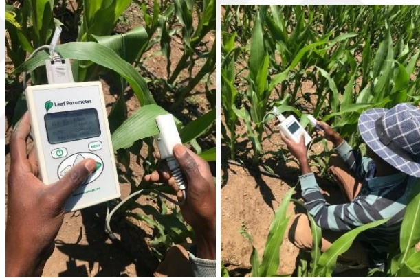
Şekil 35. Stoma iletkenliği ölçümü
