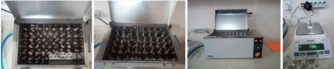
Şekil 15. Tane yoğunluğunun belirlenmesi
