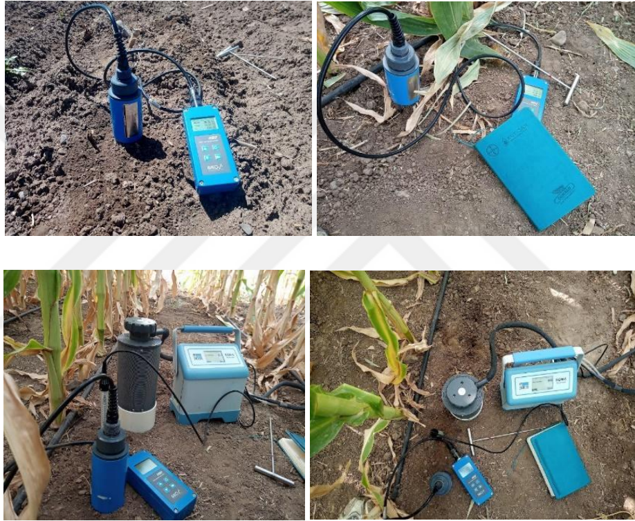
Şekil 26. CO 2 salımı, nem ve sıcaklık ölçümleri
