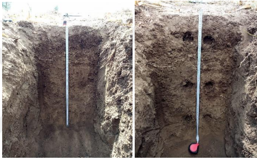
Şekil 3. Deneme öncesi bozulmuş ve bozulmamış toprak örneklerinin alınması
