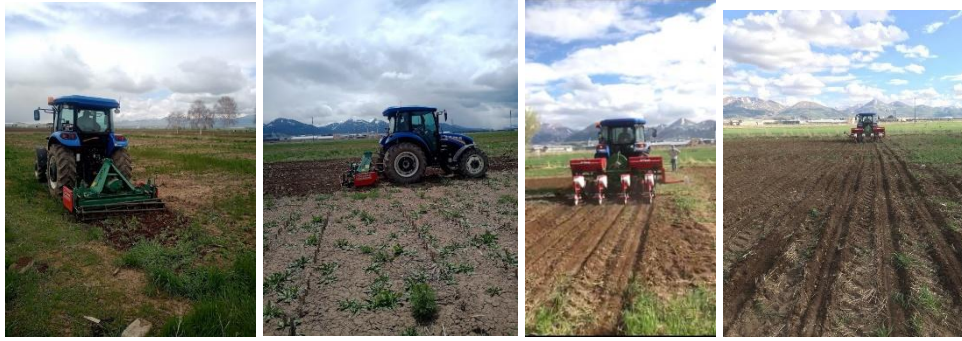
Şekil 9. Dik rotovatörle toprak işleme ve pnömatik mibzerle ekim
