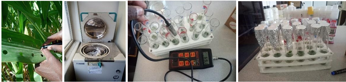
Şekil 38. Membran zararlanma indeksinin belirlenmesi
