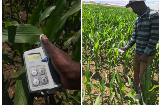
Şekil 34. Klorofil içeriği (SPAD) ölçümü
