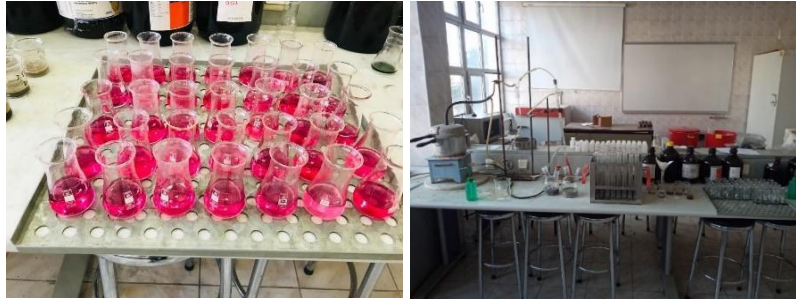
Şekil 32. Bitkide toplam Kjeldahl N içeriğinin belirlenmesi
