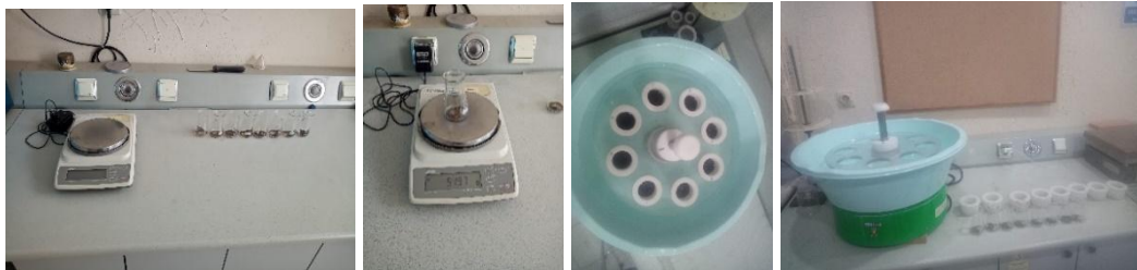
Şekil 16. Islak agregat stabilitesinin belirlenmesi
