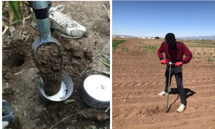
Şekil 13. Gravimetrik yöntemle toprak nem örneklenmesi
