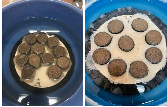
Şekil 24. Tarla kapasitesi ve solma noktasında tutulan nem miktarının belirlenmesi
