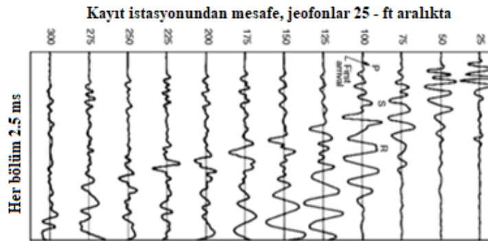
Şekil 16. Dalgaformlarının sismogramları 25 ft aralıkta 300 lb ağırlıktaki düşüşle neden olan kayıtlardır (Hunt 2005).
