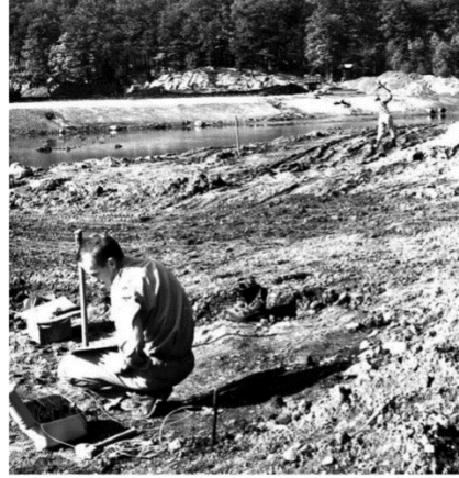
Şekil 15. Tekli kanal kırılma sismografı ve metal plakaya balyozla vuran çalışan sismik dalgalar üretmektedir (Hunt 2005).
