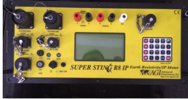
Şekil 46. Elektrik öz direnç ölçüm ekipmanı
