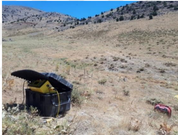
Şekil 47. Elektrik öz direnç ölçümü arazi çalışması
