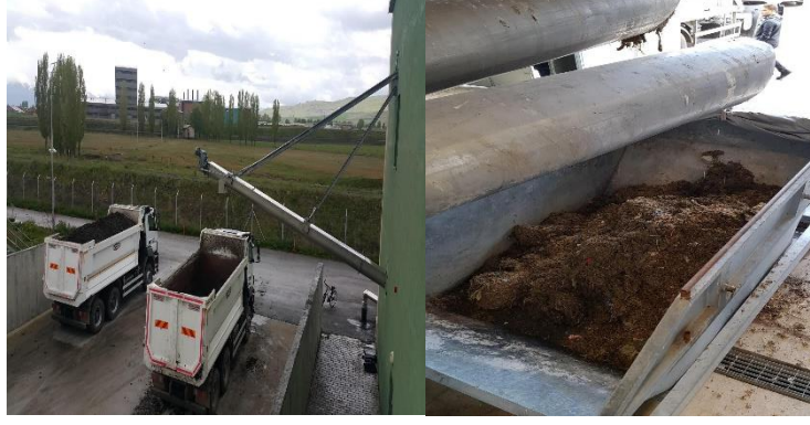
Şekil 9. Çamur çürütücünden (digester) çıkan ve kamyonlara yüklenen stabilize atık çamur
