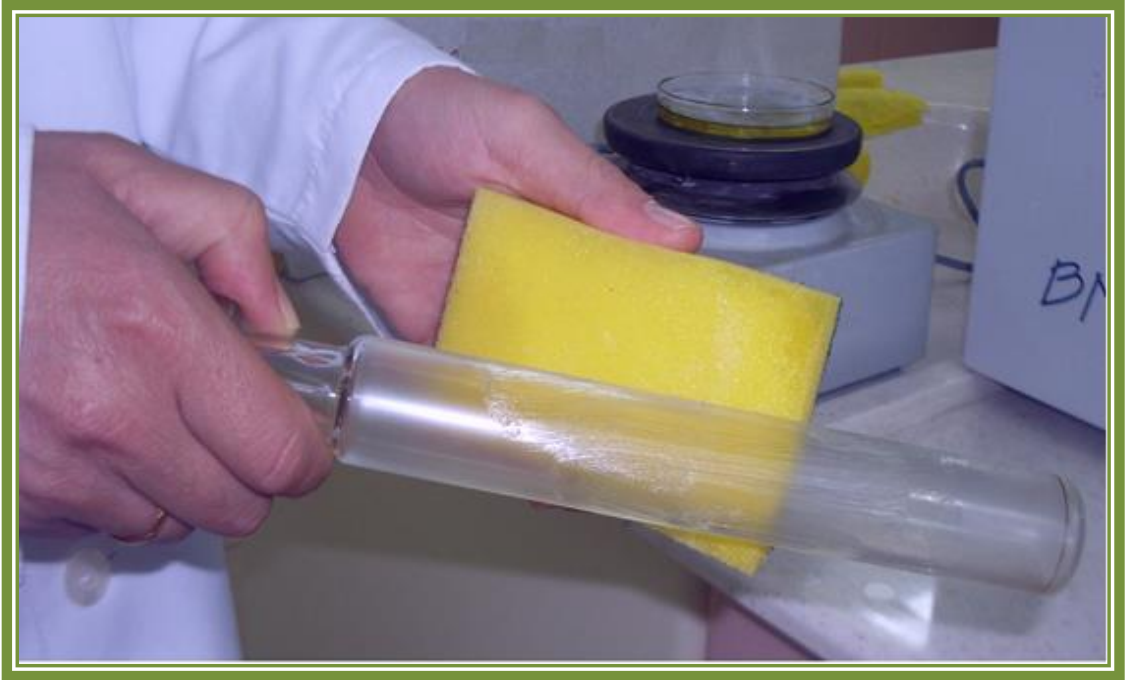
Şekil 3.34. Pistonların vazelinle yağlanması
