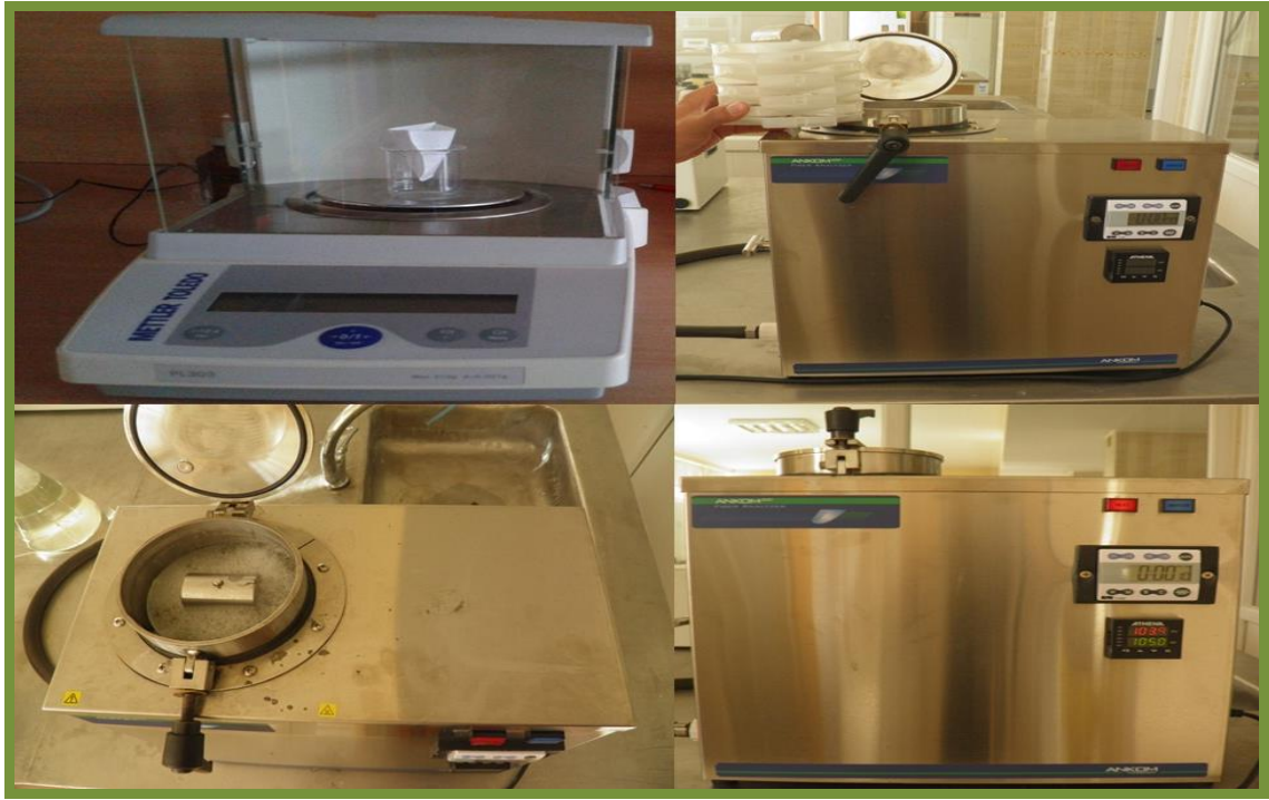
Şekil 3.28. Yem örneklerinin ADF ve NDF tayini için ANKOM cihazında muamele edilmesi
