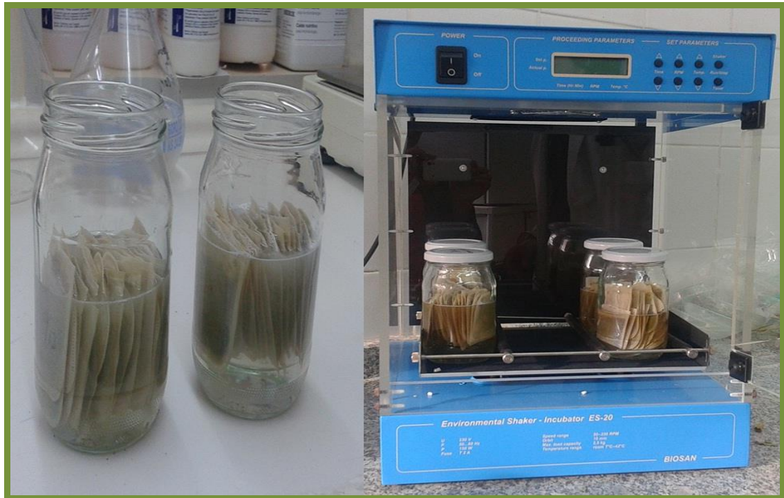
Şekil 3.29. Yem örneklerinin ADL analizi için H 2 SO 4 içerisinde 30 dk. çalkalanması
