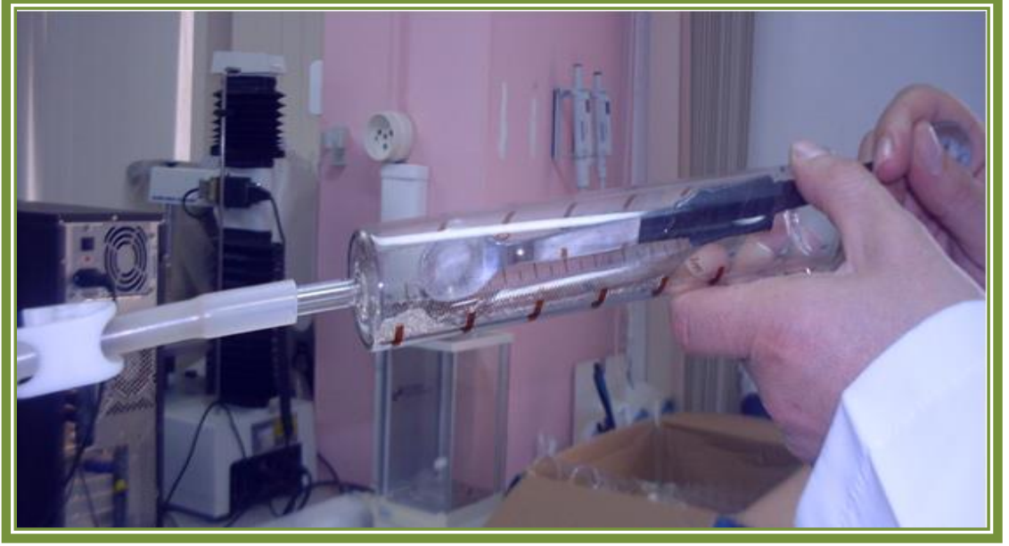
Şekil 3.33. Yem örneklerinin enjektörlere yerleştirilmesi
