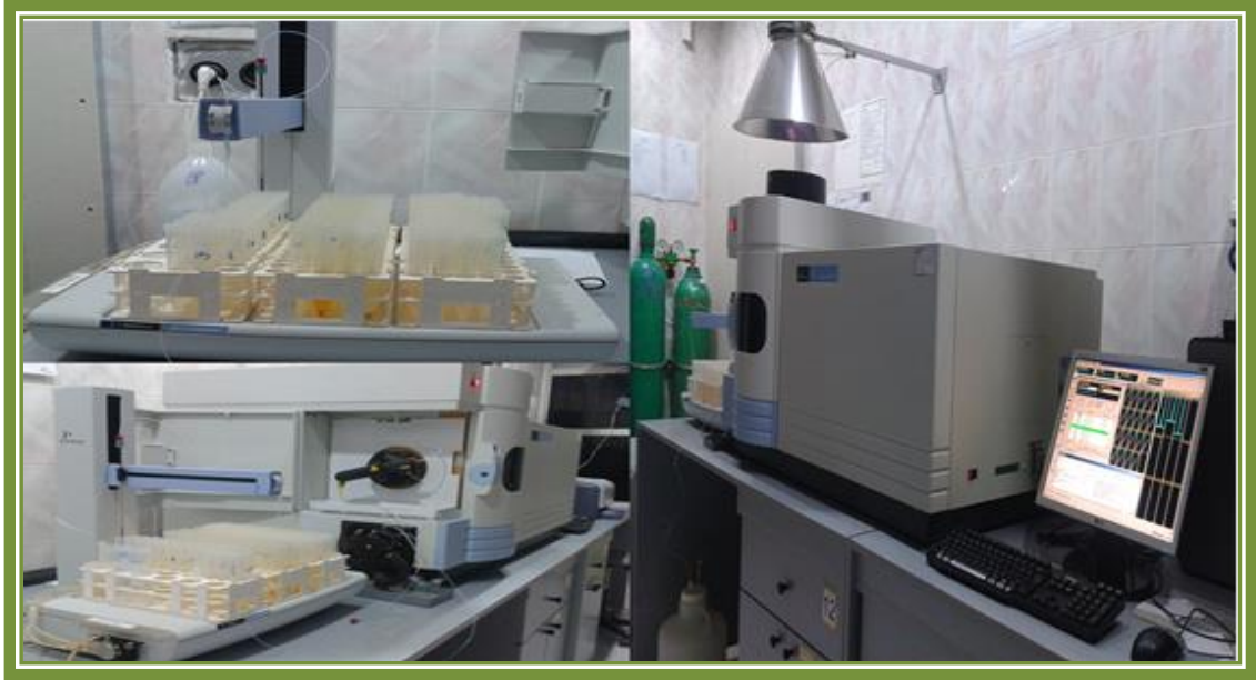
Şekil 3.32. Yem örneklerinin mineral madde içeriklerinin ICP OES Spektrofotometresinde okunması
