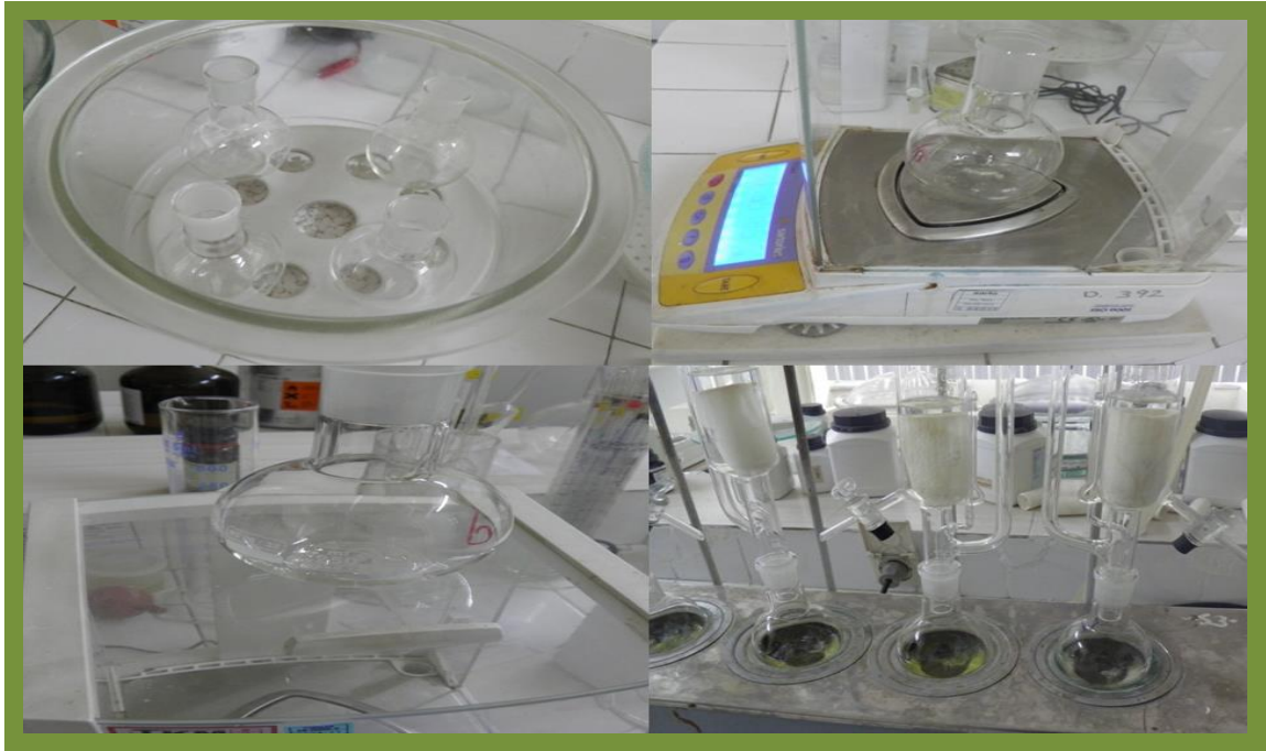
Şekil 3.25. Yem örneklerinde ham yağ analizi için materyaller ile yağ balonlarının desikatörde soğutulması ve balonların daraları alınıp Soxleth aletinin ekstraksiyon kısmına yerleştirilmesi
