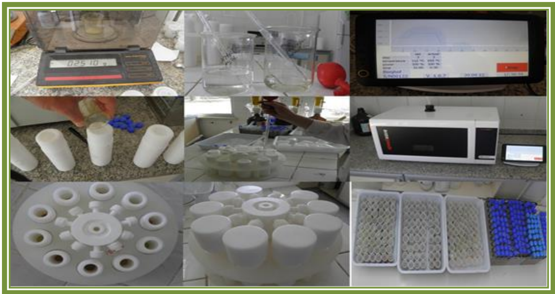
Şekil 3.31. Yem örneklerinin mineral madde içerikleri için mikrodalga, mikrowave yağ yakma ünitesine tabi tutulması
