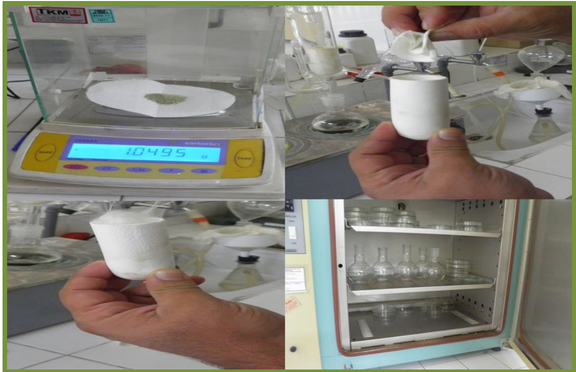
Şekil 3.24. Yem örneklerinde ham yağ analizi için örnek tartımı ile kartuş ve yağ balonlarının kurutma dolabında bekletilmeleri
