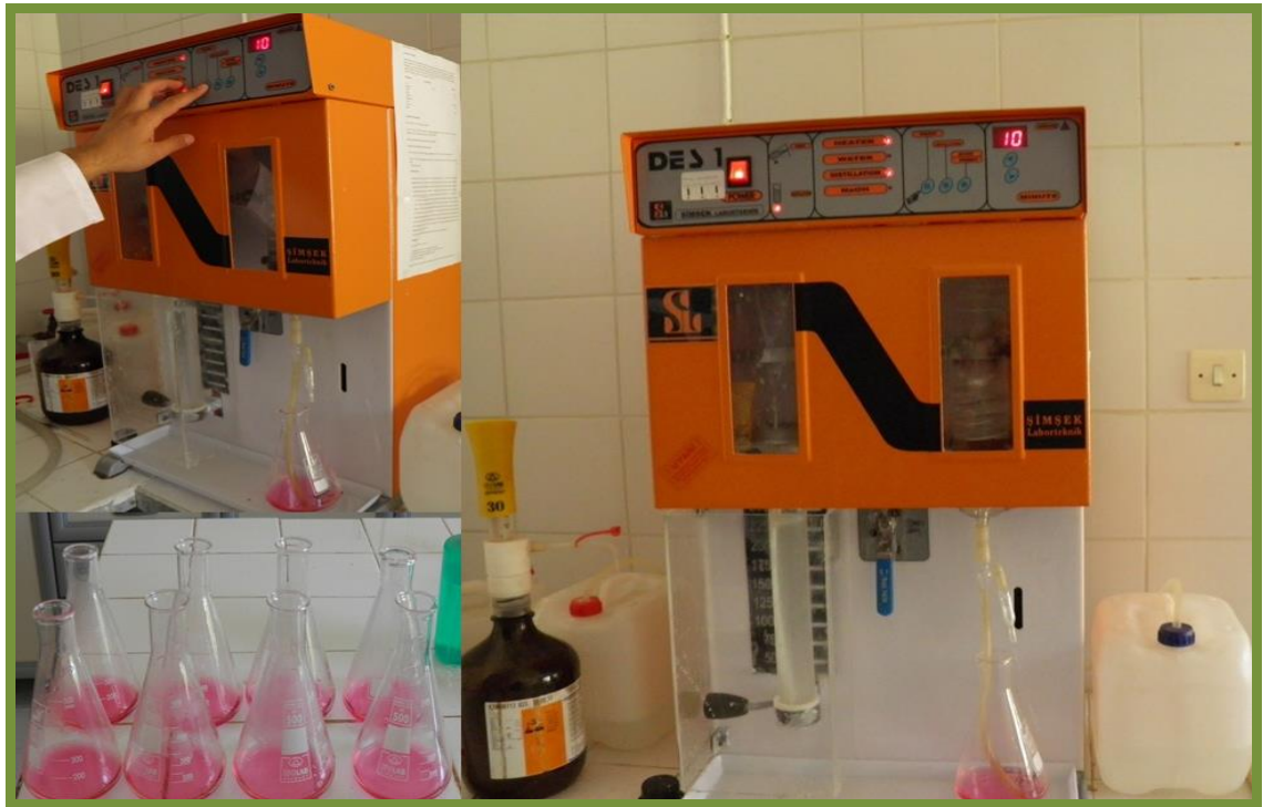
Şekil 3.22. Yem örneklerinde ham protein analizi için destilasyon yapılması
