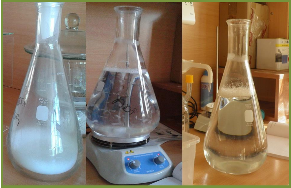
Şekil 3.27. Yem örneklerinde ADF tayini için çözelti hazırlanması
