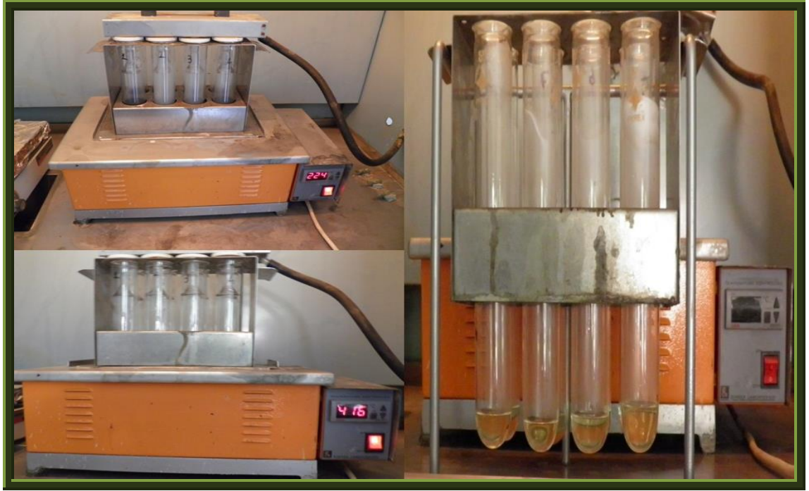
Şekil 3.21. Yem örneklerinde ham protein analizi için yaş yakma yapılması
