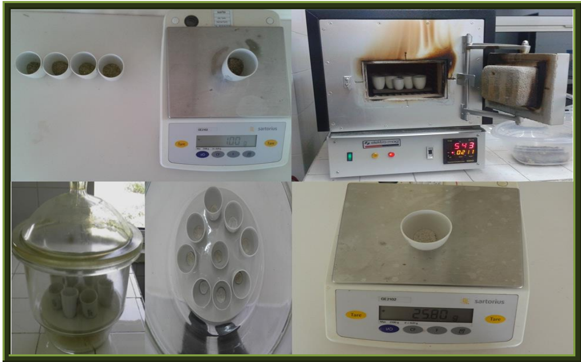
Şekil 3.20. Ham kül ve organik madde tayini için yakmadan önce yem örneklerinin tartılması, yakma fırınında yakılması, desikatörde soğutulması ve yem örneklerinin tartılması
