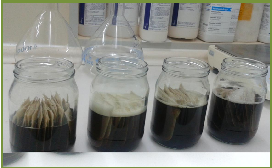
Şekil 3.30. Yem örneklerinin ADL analizi için H_2SO_4 içerisinde 3 saat bekletilmesi
