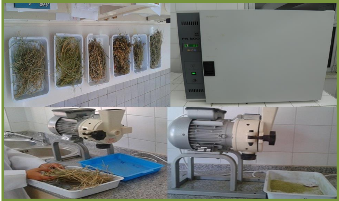
Şekil 3.16. Kurutulmak üzere laboratuara getirilen yem örneklerinin 65°C’de etüvde kurutulması ve kurutulan yem örneklerinin öğütülmesi
