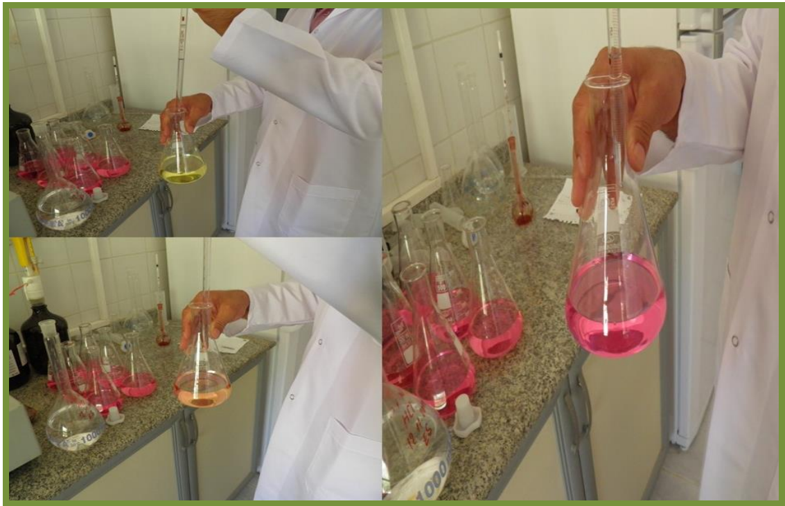
Şekil 3.23. Yem örneklerinde ham protein analizi için titrasyon yapılması
