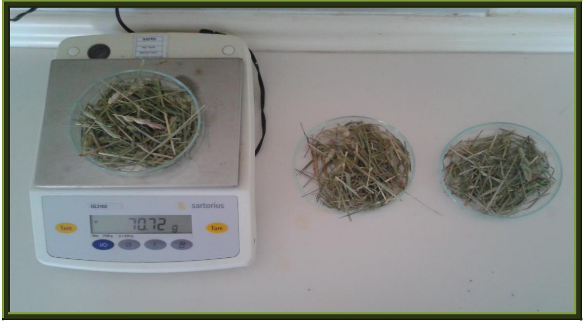
Şekil 3.19. Yem örneklerinin kuru madde tayini için hassas terazide tartılması
