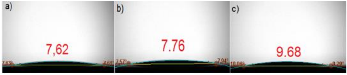
Şekil 40. Ti-Ag İFMC Kaplama Temas Açısı a) 316L b) CoCrW c) Ti6Al4V
