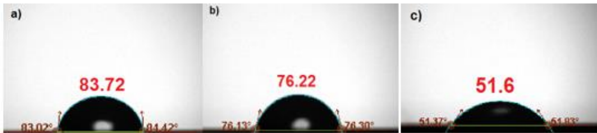
Şekil 38. Altlık Malzeme Su Temas Açısı a) 316L b) CoCrW c) Ti6Al4V
