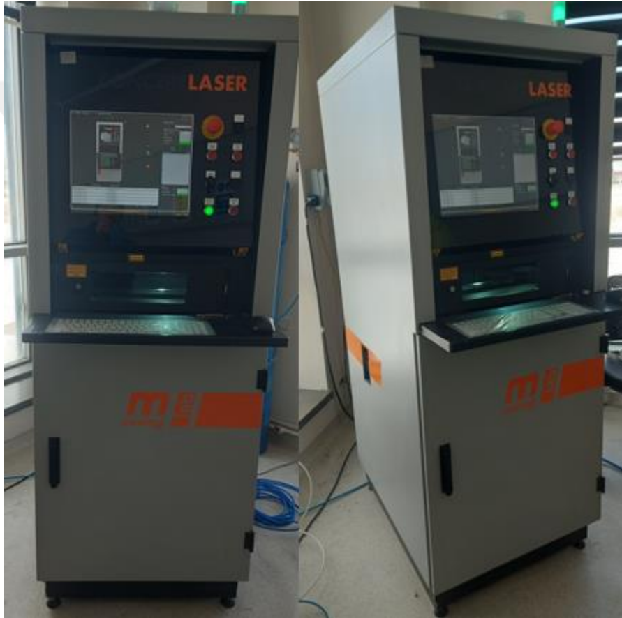
Şekil 14. Concept Laser'den Mlab Cusing Cihazının İki Açıdan Görünüşü
