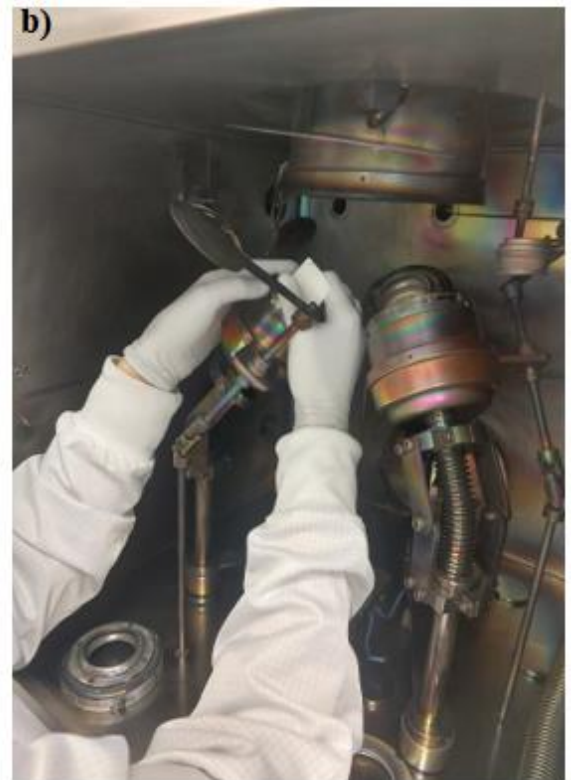
Şekil 17. Vaksis PVD Magnetron Saçtırma Cihazı a) Dıştan Görünüş b) İç Kısımın Görünüşü
