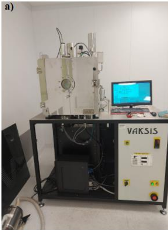
Şekil 17. Vaksis PVD Magnetron Saçtırma Cihazı a) Dıştan Görünüş b) İç Kısımın Görünüşü
