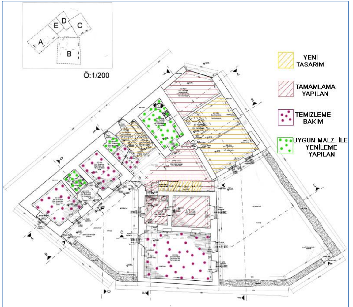
Şekil 95. Işıklılar Konağı restorasyon projesi (zemin kat) (EKVKBKM 2022).
