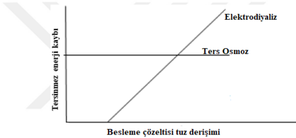
Şekil 2.15. Besleme çözeltileri tuz derişiminin fonksiyonu olarak elektrodializ ve ters ozmozdaki tersinmez enerji kaybı için şematik gösterimi (Strathmann 1994)
