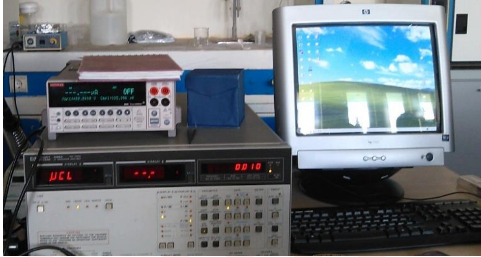
Şekil 3.5. I - V (akım-voltaj) ve C - V (kapasite-voltaj) ölçüm sistemleri
