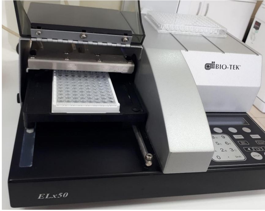
Şekil 23. İmmünoglobulin analizleri için kullanılan plaka yıkama cihazı
