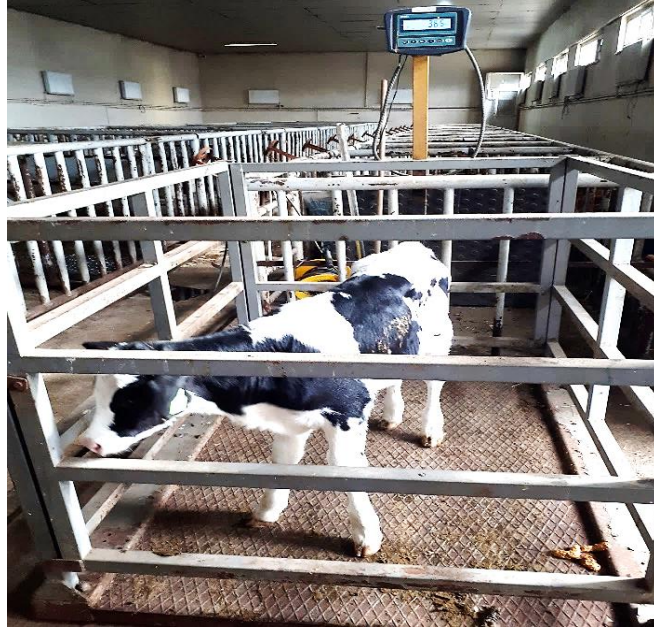
Şekil 11. Buzağların tartılmasında kullanılan hayvan baskülü
