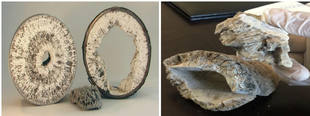
Şekil 5.1. ERBASAT çamur hattında oluşan strüvit malzeme
