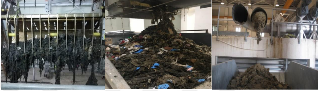
Şekil 2.1. Kepçe tipi ızgara, mekanik kaba ve ince ızgaralarda tutulan atıklar
