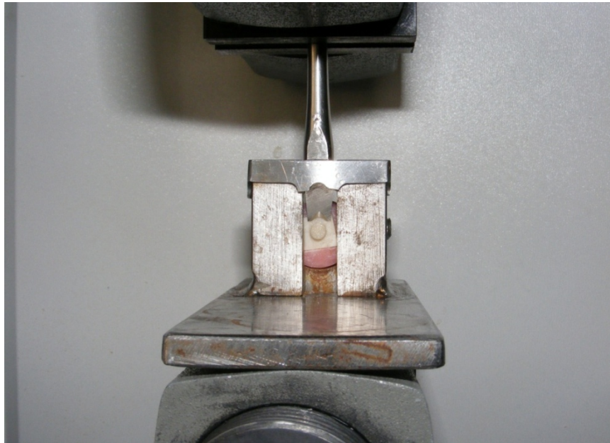
Şekil 3.24. Veneer porseleni - zirkonyum oksit alt yapı ara yüzeyine uygulanan kesme (shear) testi
