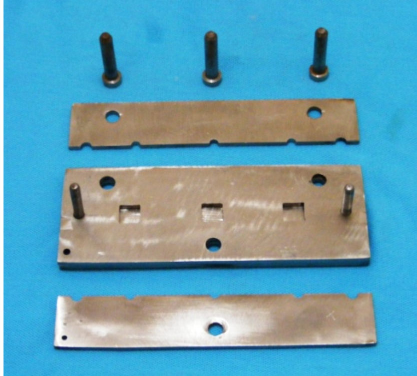
Şekil 3.14. Metal kalıbı oluşturan tabakaların genel görüntüsü
