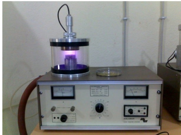
Şekil 3.11. Polaron altın kaplama cihazı
