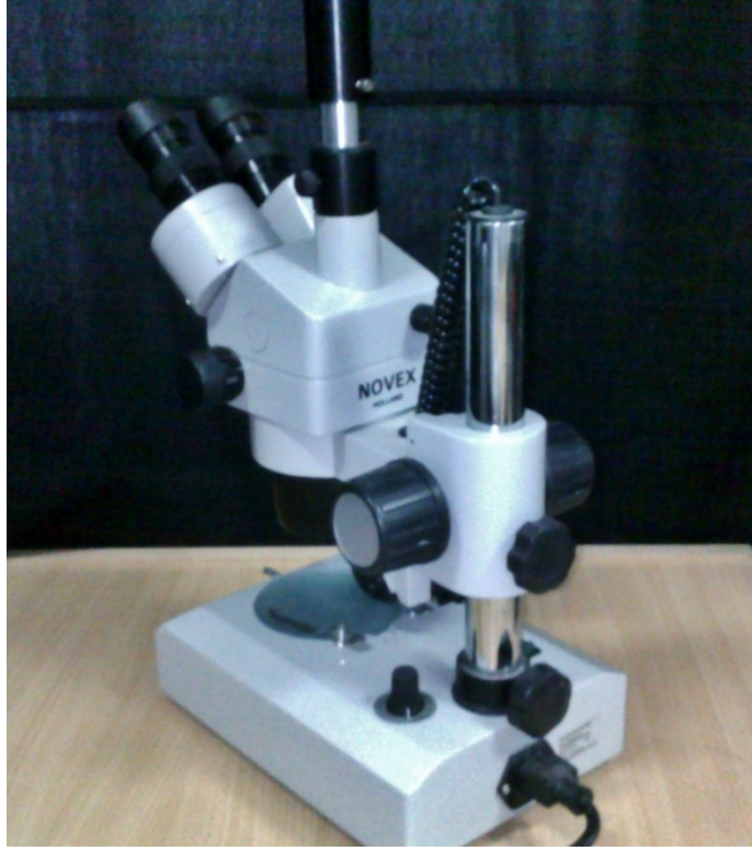
Şekil 3.25. Kopma şekillerinin incelendiği optik mikroskop
