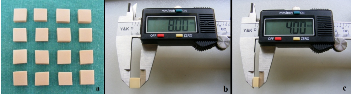
Şekil 3.5. a.Sinterlenmiş alt yapı örnekler
