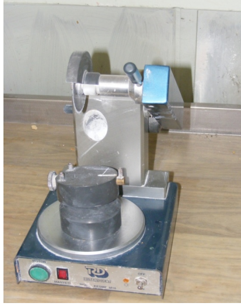
Şekil 3.2. Alt yapıların hazırlandığı model kesme makinesi
