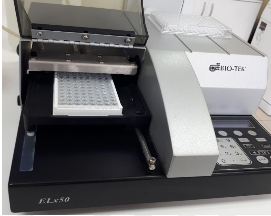
Şekil 23. İmmüoglobulin analizleri için kullanılan plaka yıkama cihazı
