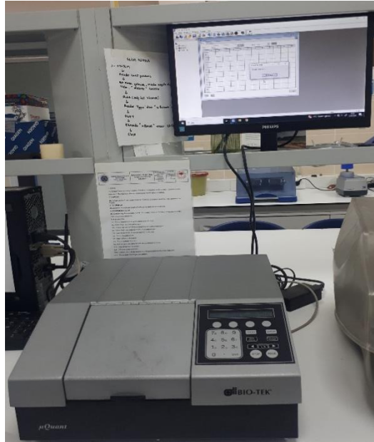
Şekil 26. İmmünoglobulin analizleri için kullanılan ELISA absorbands okuyucu cihaz
