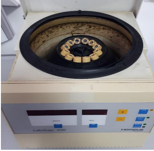
Şekil 20. Kan serumu eldesi için kullanılan santrifüj cihazı
