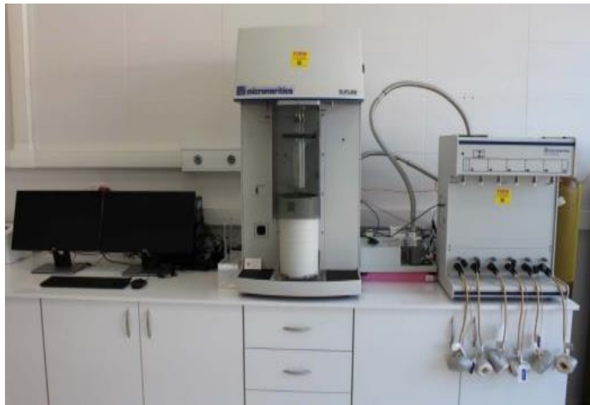
Şekil 15. Micromeritics 3 Flex model yüzey alanı ölçüm cihazı (BET).
