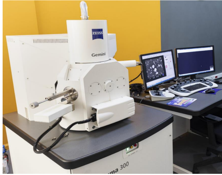
Şekil 11. Zeiss Sigma 300 model taramalı elektron mikroskobu (SEM).
