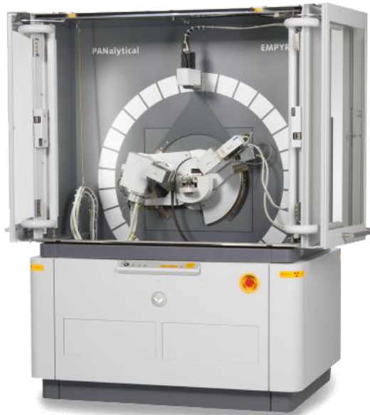
Şekil 16. PANalytical Empyrean model X-ışını Difraktometresi (XRD).
