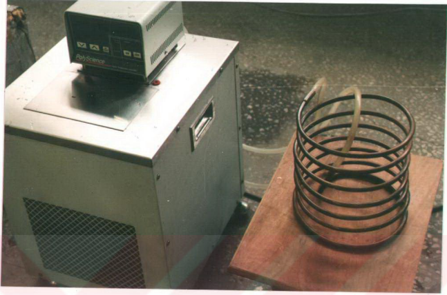
Şekil 3.8. Sabit sıcaklık banyosu ve bakır spiral boru.
