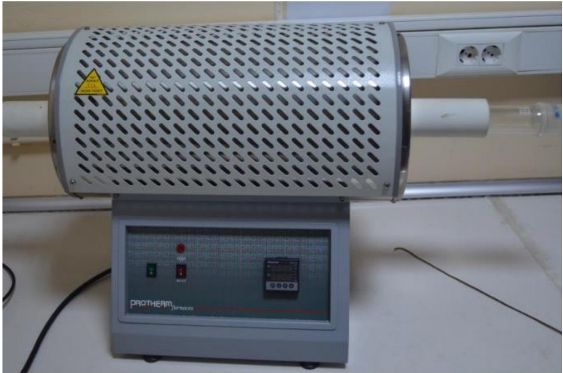
Şekil 24. Tek bölmeli tavlama fırını
