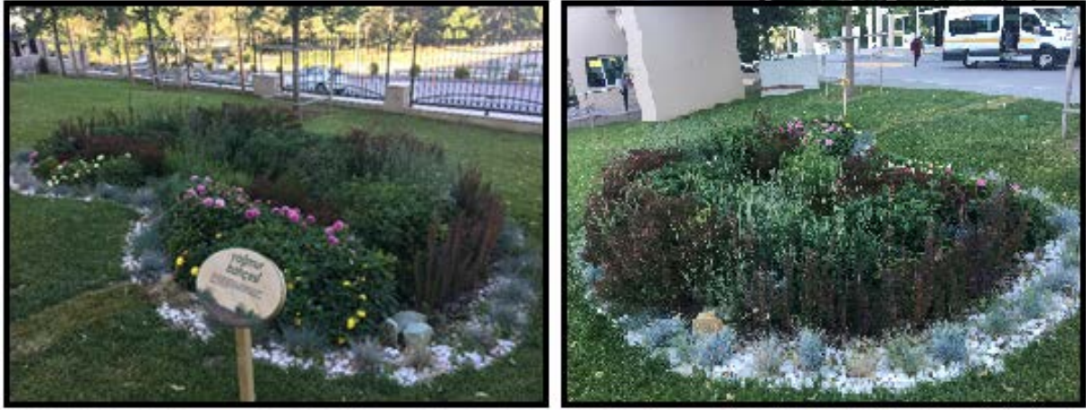
Şekil 8. Parsel içerisinde kullanılan yağmur bahçesi örneği(CSB, 2018).
