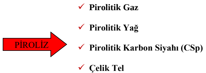
Şekil 3. Piroliz Akış Şeması ve Ürünleri (Yakaboylu, 2010)
