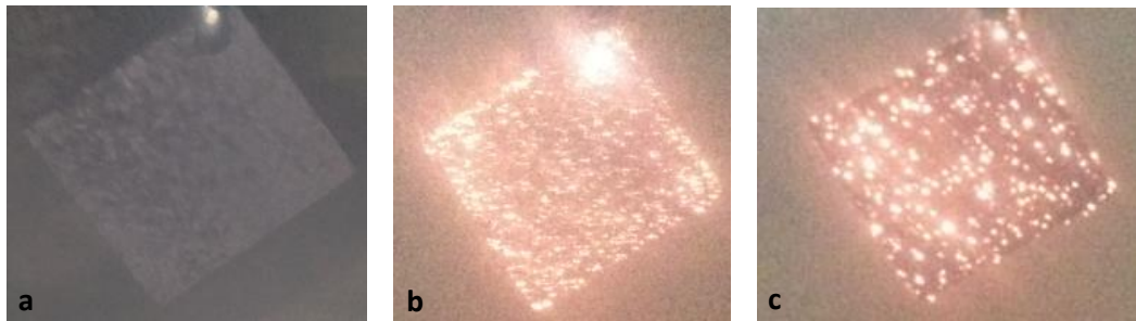
Şekil 2.10. MAO sisteminde oluşan mikro boşalmalar
