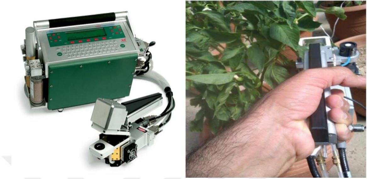
Şekil 3.15. Çalışmada kullanılan LI-6400XT (LI-COR, USA) portatif fotosentez ölçer (Orijinal)
