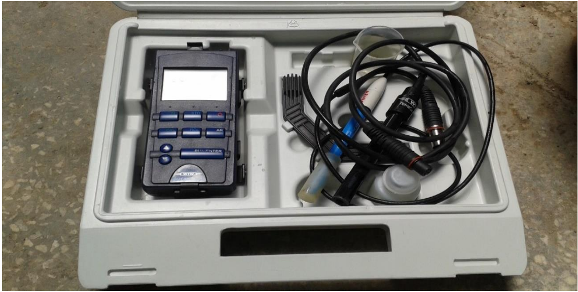
Şekil 3.9. Topraktaki tuz konsantrasyonunu ölçmeye yarayan cihaz (Orijinal)
