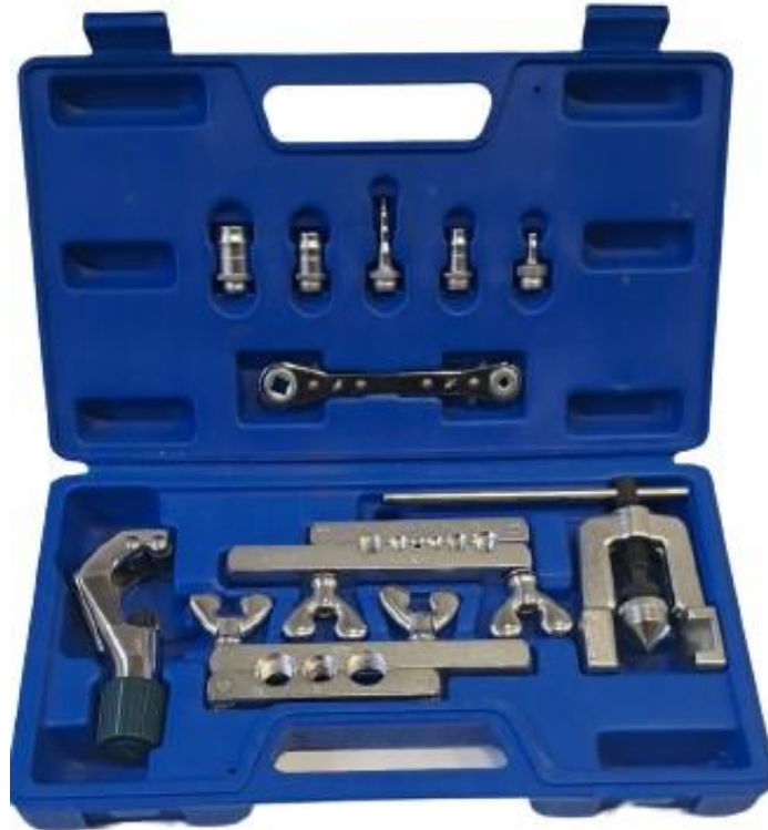
ekil 69. Bakır boru havřa ve muf ama seti.
