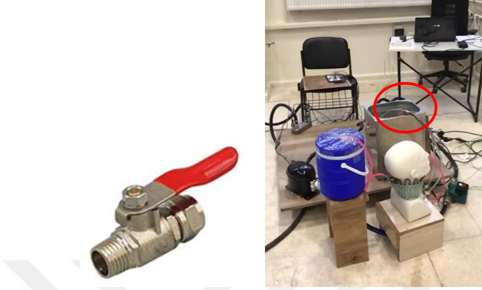
Şekil 49. Boyun bölgesi kan debisi miktarı ayarlama vanası ve deney sisteminde görünümü.
