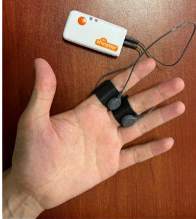
Şekil 8. Shimmer GSR cihazı ve elektrotlarının konumlandırma şekli
