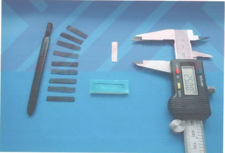
Resim 1: Paslanmaz çelik model, mum örneklerin çoğaltılması amacı ile kullanılan elastomerik ölçü, döküm mumundan çoğaltılmış mum örnekler.
