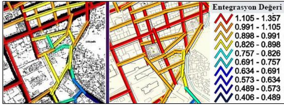
Şekil 17. Amasya Burmalı Minare Cami-Taşhan-Kapalı Çarşı aksının bulunduğu alanın mevcut durumda ve öneri projede entegrasyon değerleri (Altınöz, 2003, s. 54)
