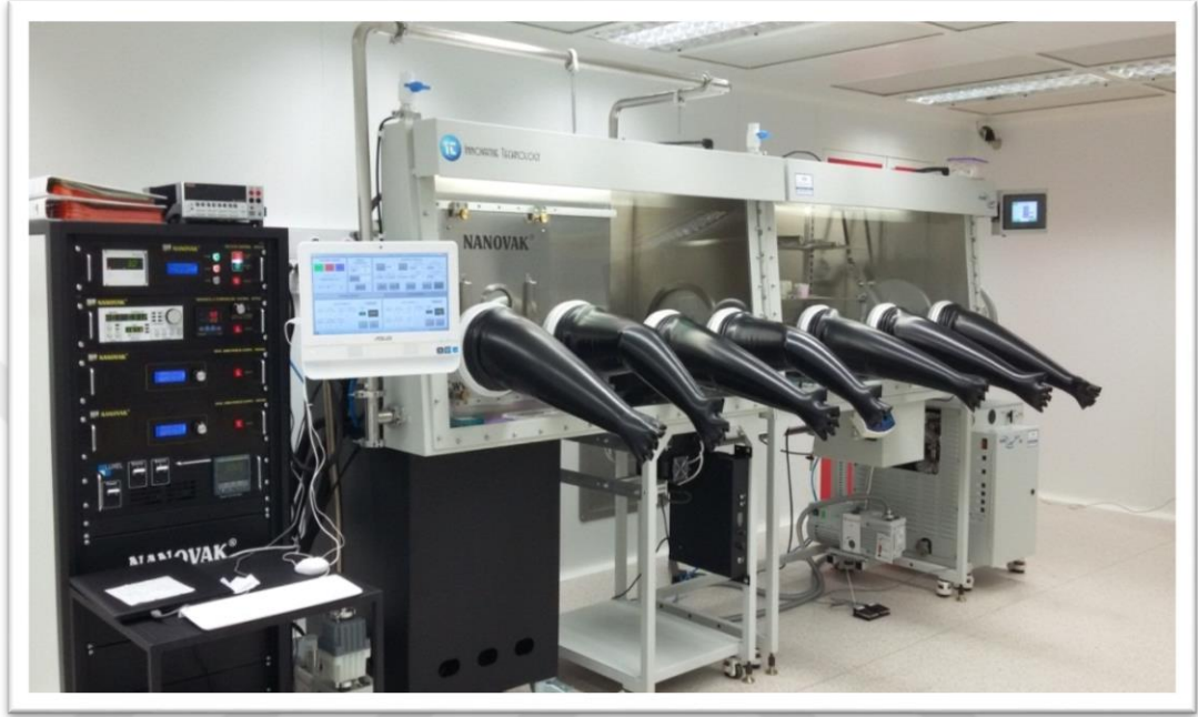
Şekil 3.1. Laboratuvar’da bulunan atmosferik kontrollü, sızdırmaz, oksijensiz eldivenli kabinin fotoğrafı
