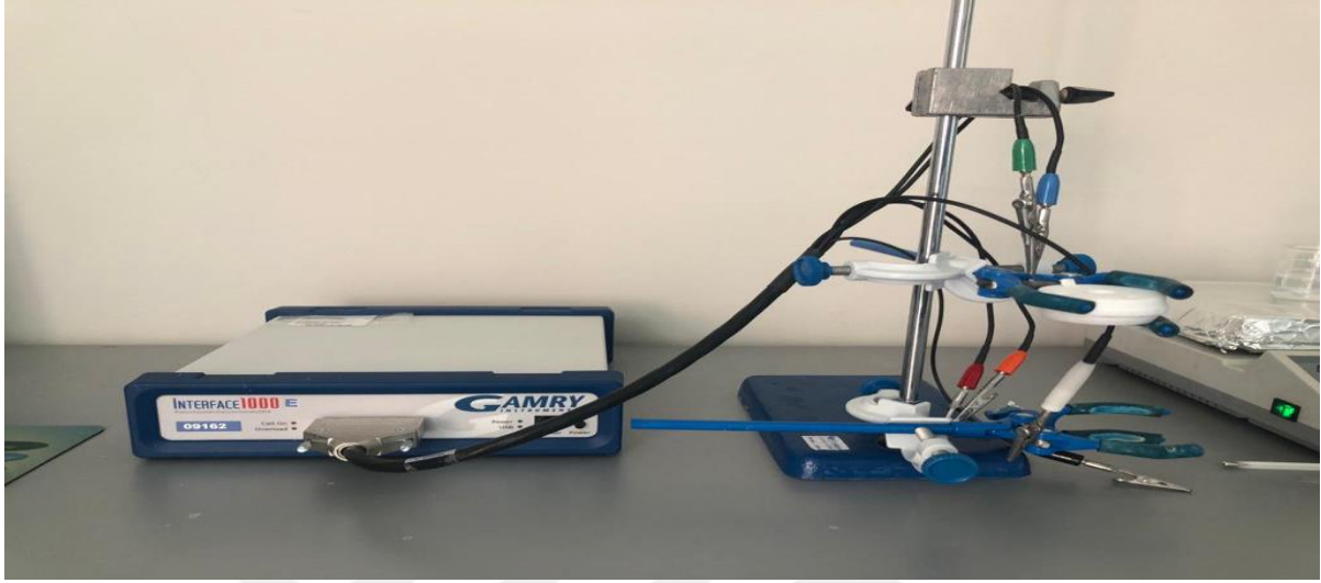
Şekil 70. Gamry potansiyostat cihazı ve üç elektrotlu test hücresi.
