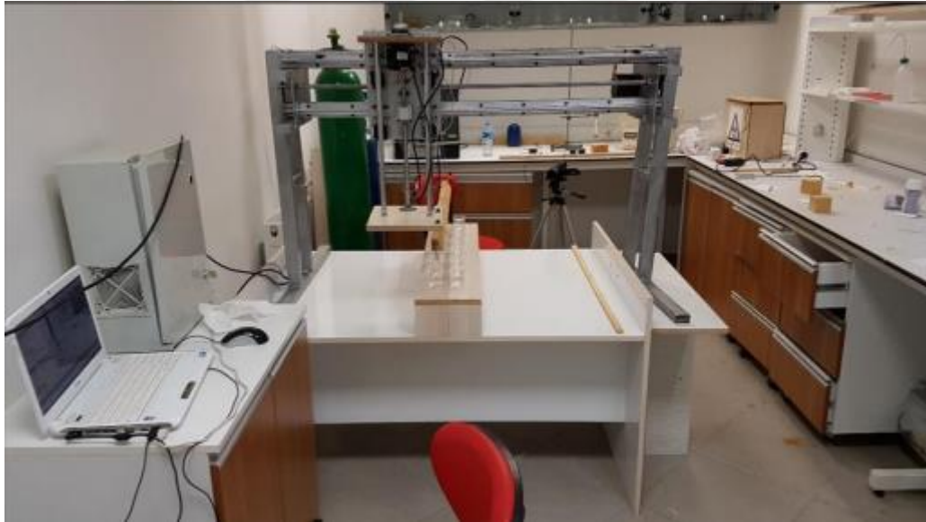
Şekil 33. Büyütme işlemlerinin gerçekleştiği SILAR cihazı.
