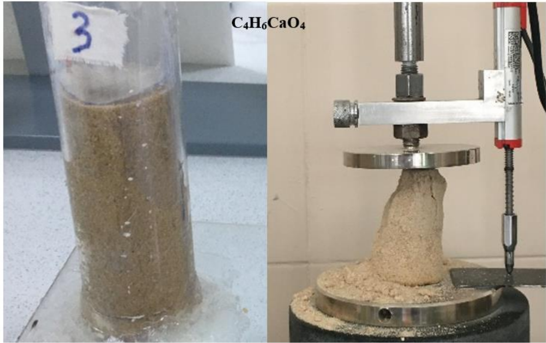
Şekil 30. Kalsiyum asetat içeren EICP çözeltisi uygulanan numune ve serbest basınç deneyine ait görsel
