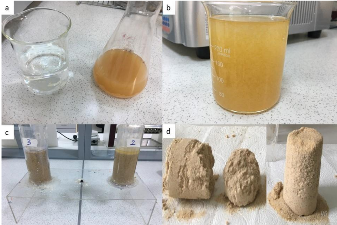
Şekil 16. Birinci yöntemin görselleri: (a) Üre-CaCl 2 ve üreaz enzim çözeltisi, (b) uygulama çözeltisi (c) uygulama çözeltisi verilen numuneler, (d) iyileştirilen numuneler
