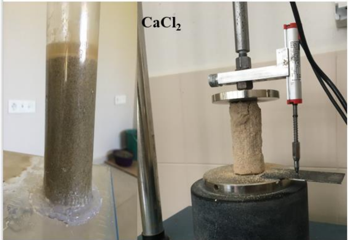
Şekil 26. Kalsiyum klorür içeren EICP çözeltisi uygulanan numune ve serbest basınç deneyine ait görsel
