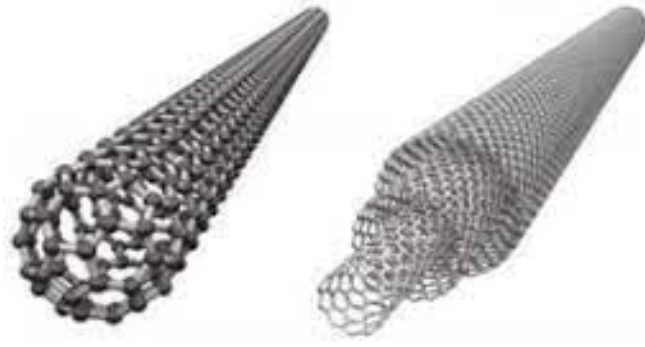
Şekil 25. (a) Tek duvarlı (b) Çok duvarlı karbon nanotüpler
