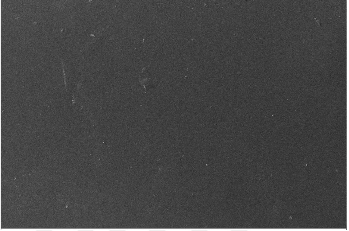
Şekil 54. K tlece % 1,5 SiC takviyeli epoksi kompozitin SEM g r nt s 
