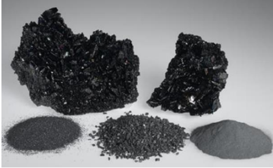
Şekil 23. Silisyum karbür taneleri ve toz hali (Anonim, 2022)
