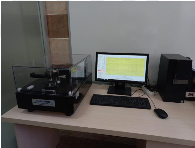
Şekil 30. Pin-on-Disk deney düzeneği görseli
