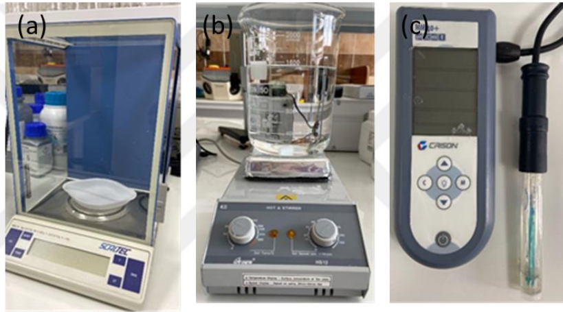
Şekil 29. SBF hazırlanması için kullanılan hassas terazi (a), ısıtıcılı manyetik karıştırıcı (b), pH ölçer (c)
