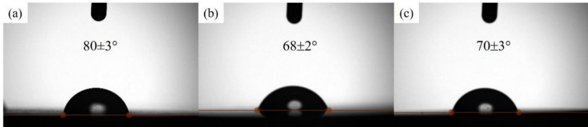
Şekil 39. (a)Kaplamasız 316L, (b)-TNTZ-Cr (c)-TNTZ-Mo kaplamalı numunelerin ıslanabilirlik analizi
