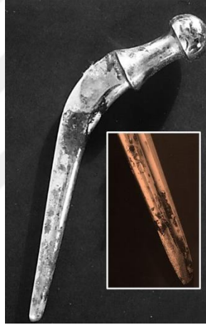
Şekil 11. Korozyona uğramış bir kalça protezi (Walczak et al., 1998).
