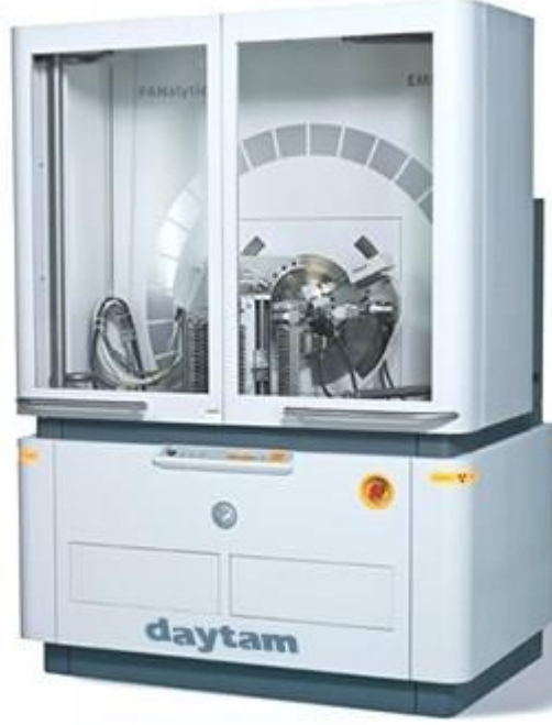
Şekil 3.1. BN tozlarının kırınım desenlerinin elde edildiği PANalytical Empyrean X-Ray Difraktometresi (Atatürk Üniversitesi DAYTAM)
