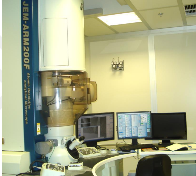
Şekil 3.3. Çalışmada kullanılan JEOL JEM-ARM200CFEG UHR marka geçirimli elektron mikroskobu (TEM) (Sabancı Üniversitesi SUNUM)
