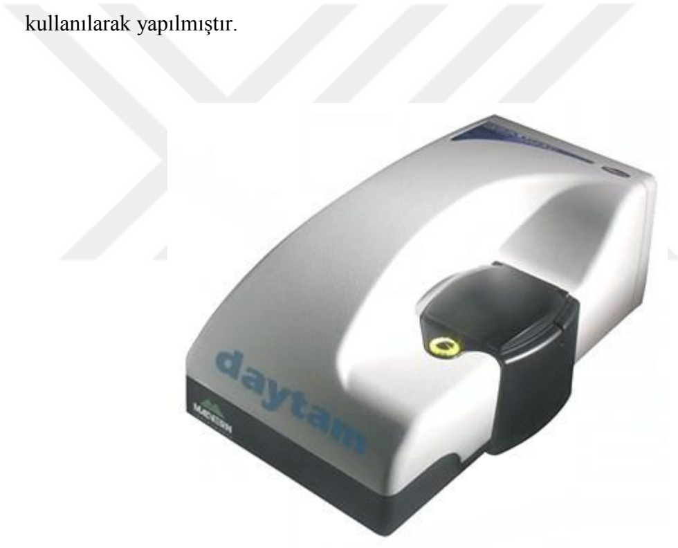
Şekil 3.4. BN tozlarının tane boyutlarını tesbit için kullanılan Malvern marka Zetasizer cihazı. (Atatürk Üniversitesi DAYTAM)
