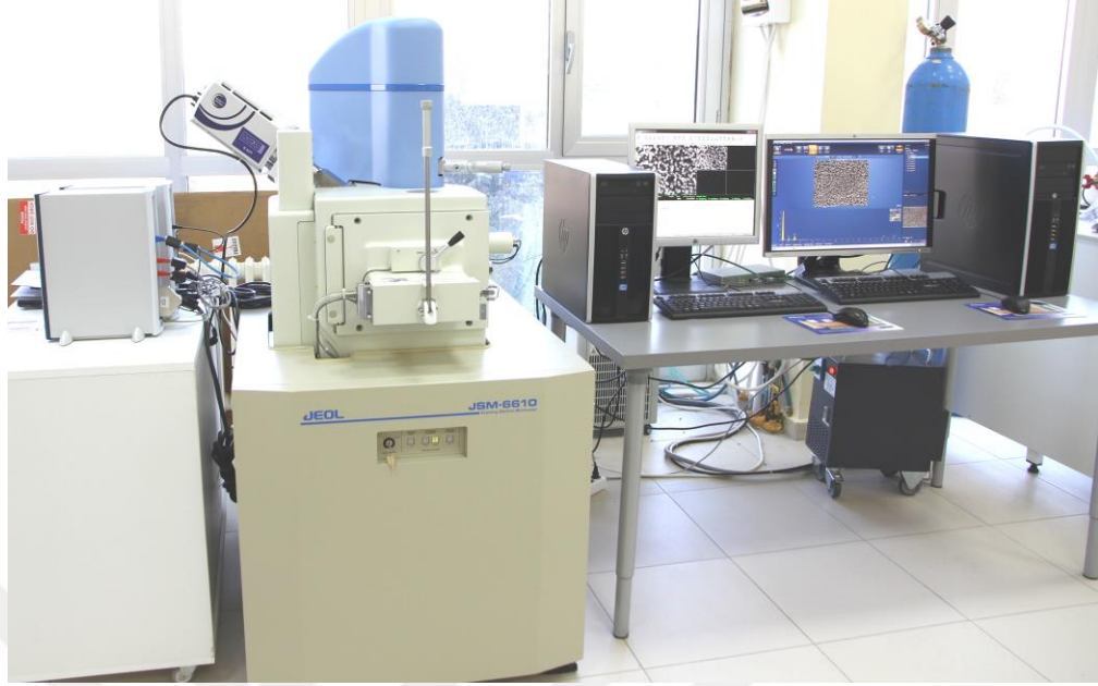
Şekil 3.2. Çalışmada kullanılan JEOL JSM6610 marka elektron taramalı mikroskop (SEM) (Recep Tayyip Erdoğan Üniversitesi Merkezi Araştırma Laboratuvarı)
